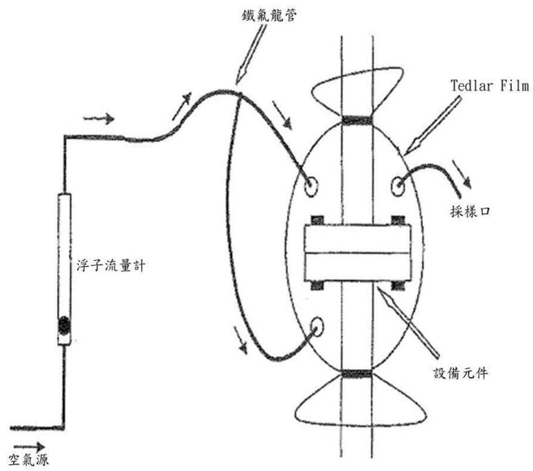
圖一 製程設備元件圍封法採樣方式
