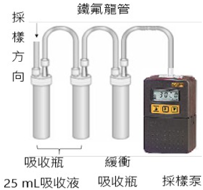
圖一 採樣設備配置圖
