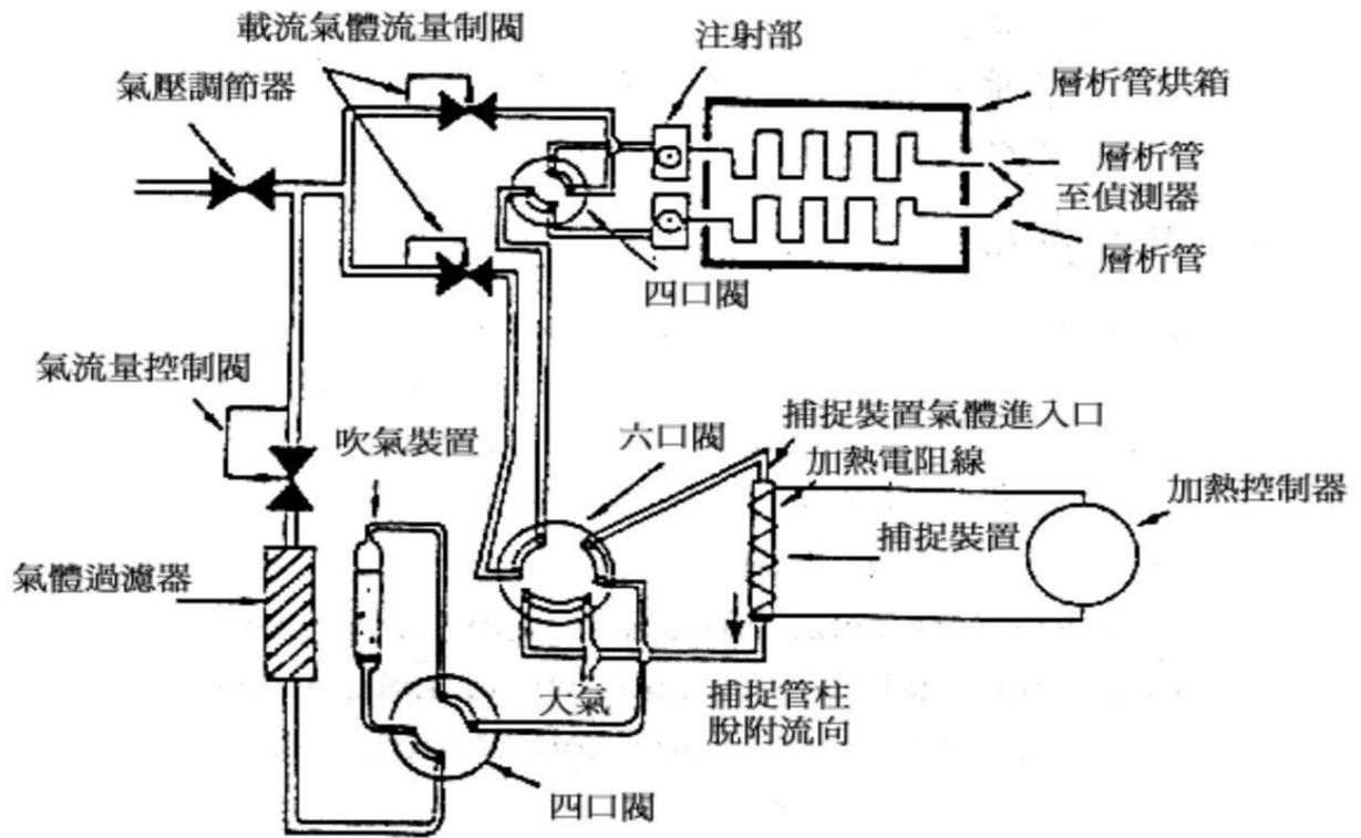
圖一 吹氣捕捉系統之捕捉圖
