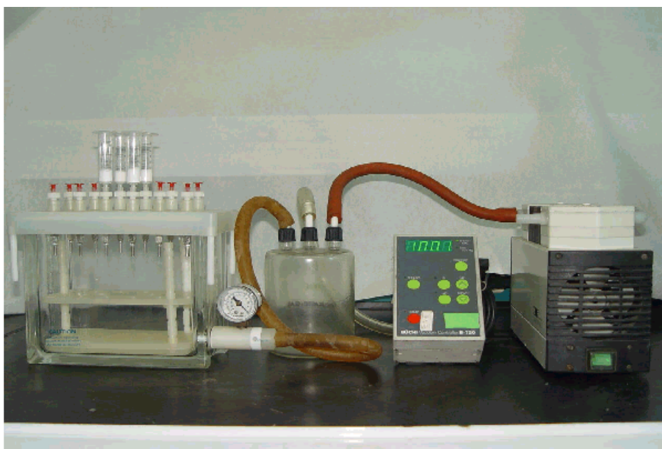
圖三 手動固相萃取管（Cartridge）萃取裝置
