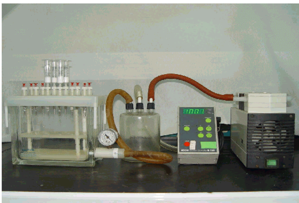
圖三 手動固相萃取管（Cartridge）萃取裝置（範例）
