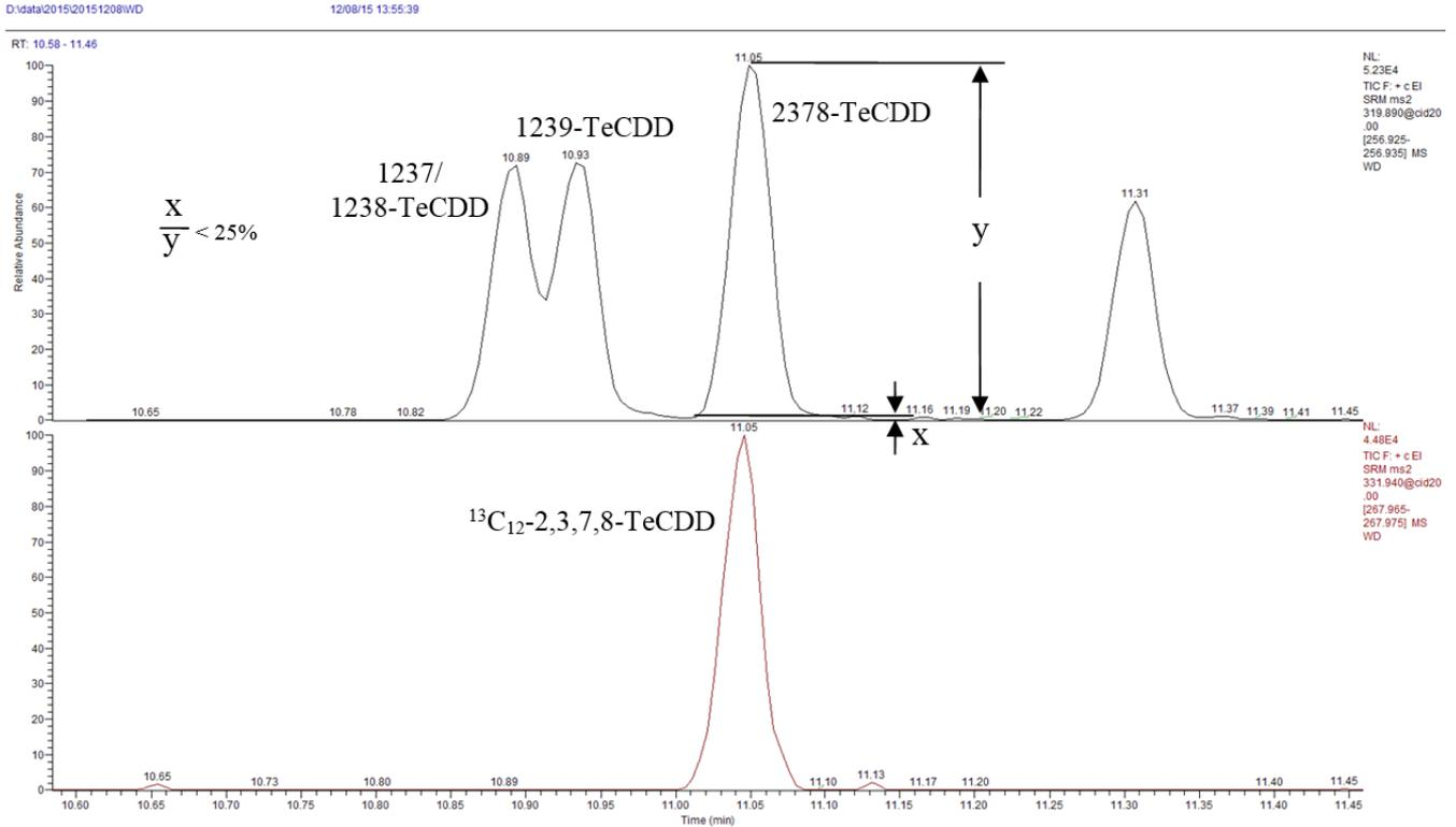
圖二、2,3,7,8-TeCDD 在 TG-Dioxin 層析管柱之解析度
