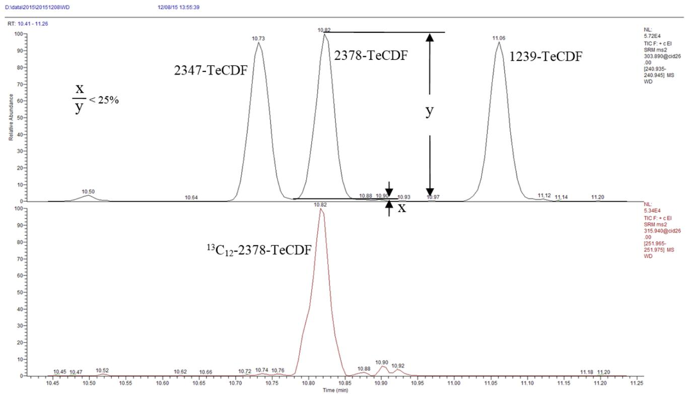
圖三、2,3,7,8-TeCDF 在 TG-Dioxin 層析管柱之解析度
