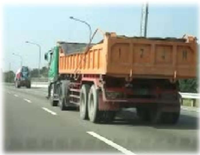
以封蓋覆蓋貨箱者，封蓋未緊密覆蓋貨箱
