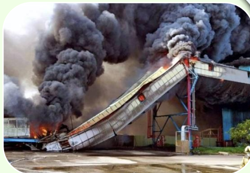
卸煤機及輸送帶失火產生明顯粒狀物
