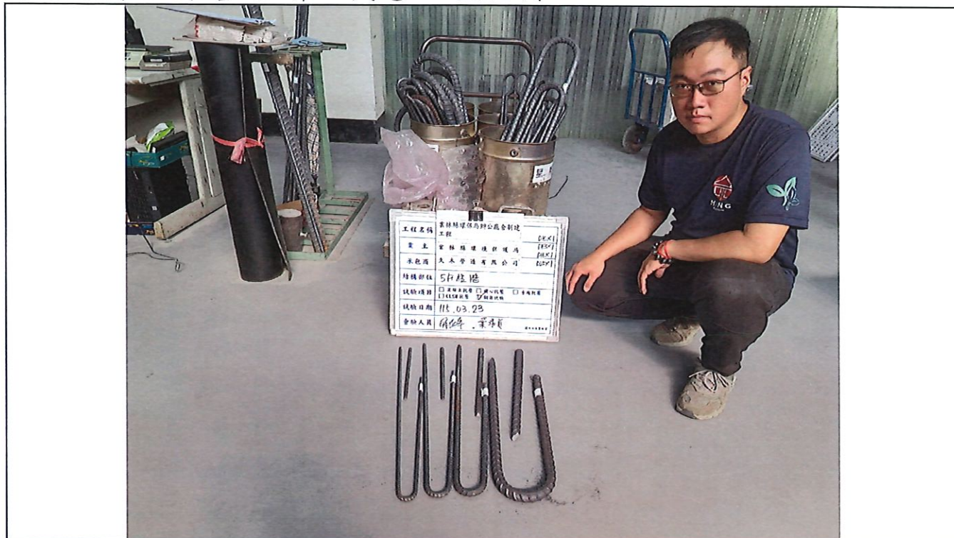
相片說明 115.03.23-5F柱牆鋼筋試驗(辦公室) 15
