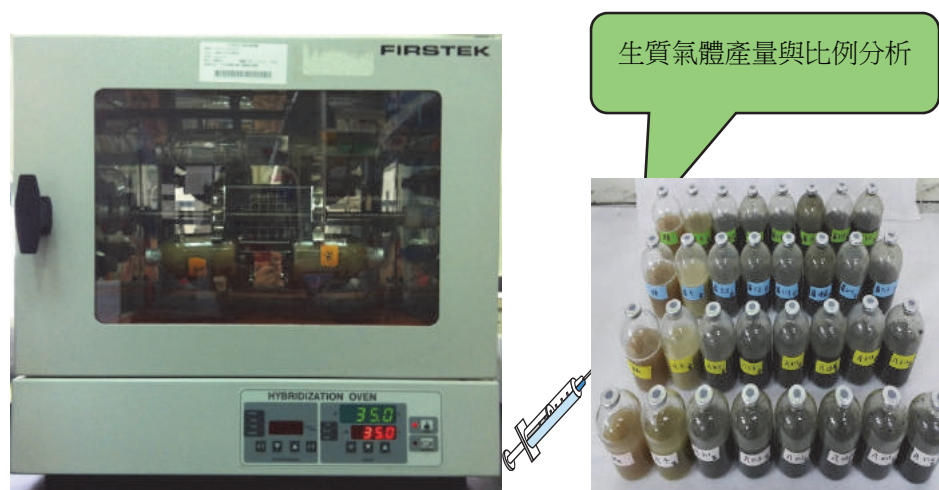
圖 3.2-2、BMP 試驗培養設備與分析示意圖
