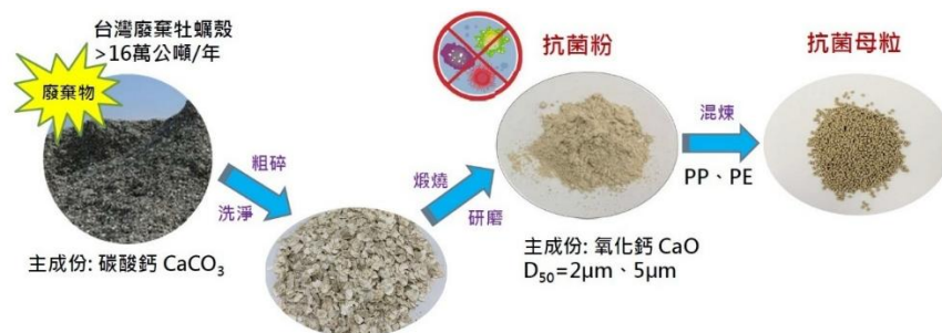
圖 2.4-2、廢棄牡蠣殼製作抗菌複合材料
