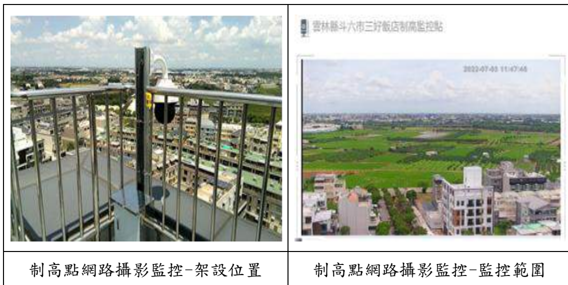
圖 3.4.2-11 AI 煙霧主動通報系統安裝情形(斗六市三好酒店)
