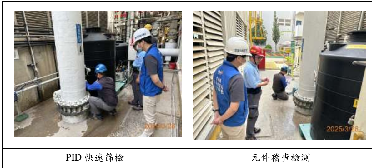
圖 5.4-2、冷卻水塔水中 VOCs 稽查檢測情形
