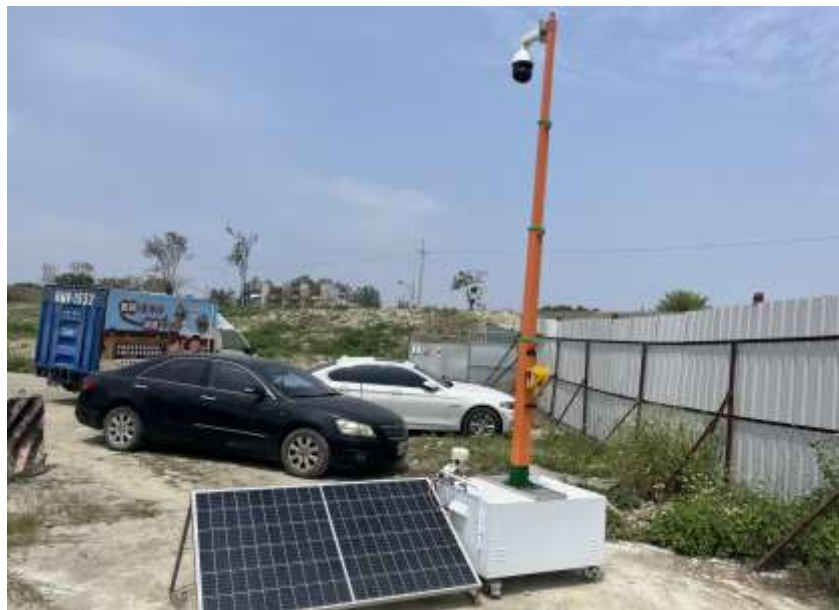
圖 9.4-8 第 8 處營建工地智能環保哨兵設置圖
