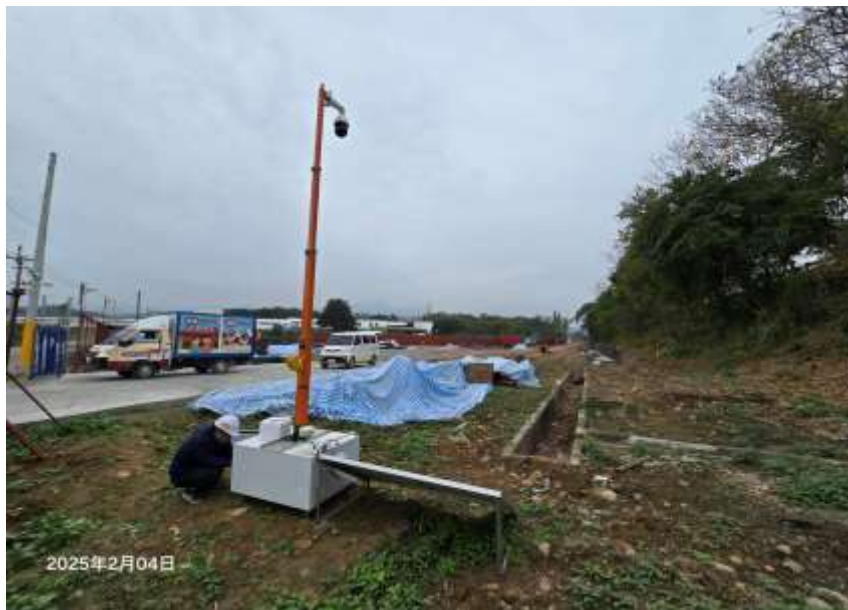
圖 9.4-4 第 4 處營建工地智能環保哨兵設置圖
