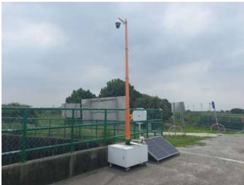
圖 9.4-11 第 11 處營建工地智能環保哨兵設置圖
