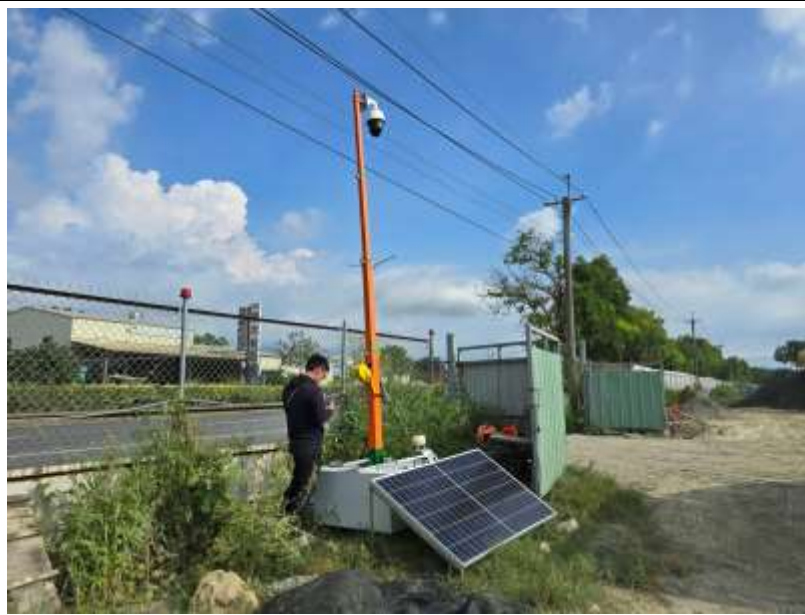
圖 9.4-12 第 12 處營建工地智能環保哨兵設置圖
