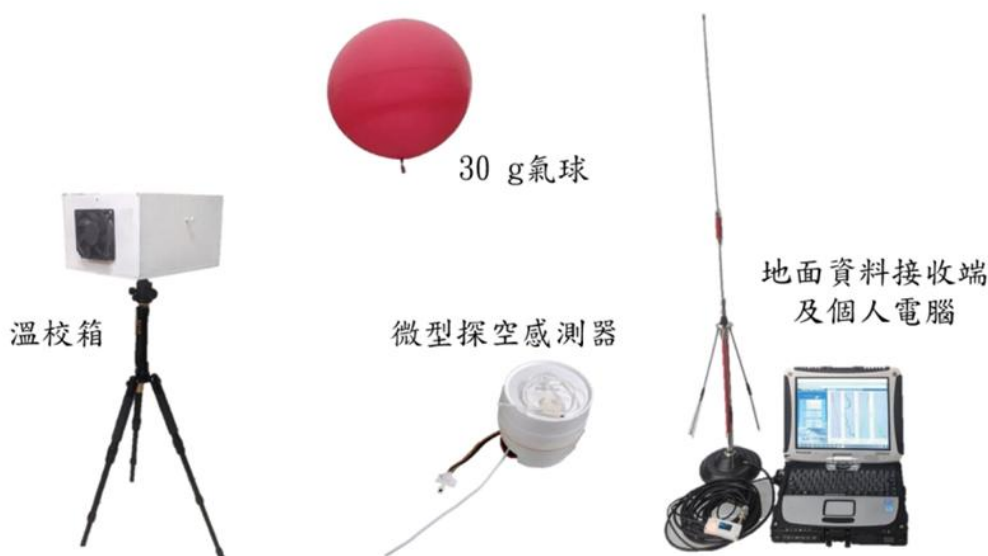
圖 3.5 探空儀器示意圖
