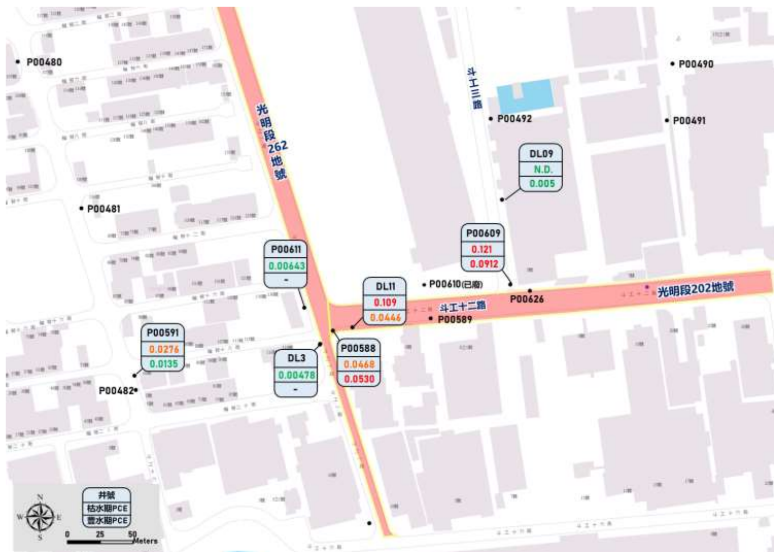
圖 4.9.3-1、斗六光明段限制區域枯豐水期地下水監測位置與四氯乙烯濃度圖
