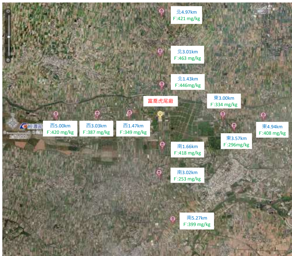
圖 4.13.1-2、103 年富喬工業(股)公司虎尾廠鄰近農地採樣位置與土壤氟化物含量
