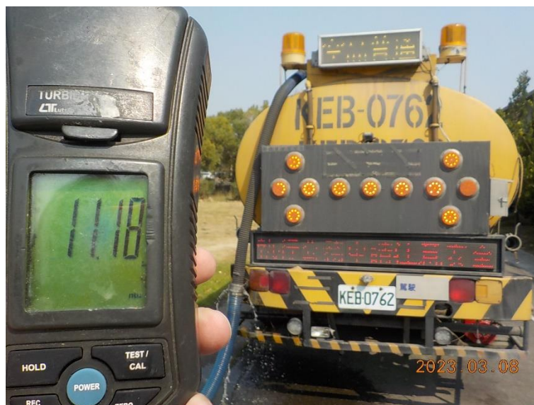
圖 3.7.2-1 使用濁度檢測計現場量測水質情形
