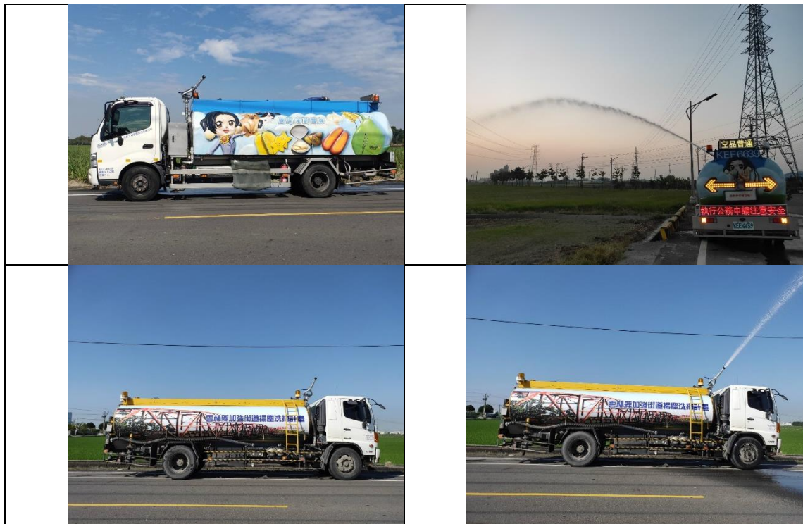
圖 3.3.6-1 洗街車輛新增消防瞄子設備
