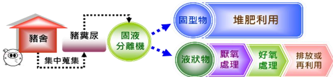
圖 4.1.1-9、三段式廢水處理流程
