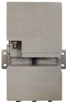
圖 5.1-1、移動式水質感測器外觀示意圖
