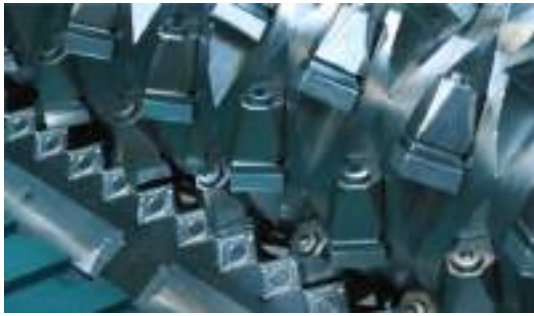
圖 4 破碎機刀具(zero gap 無縫剪切設計)
