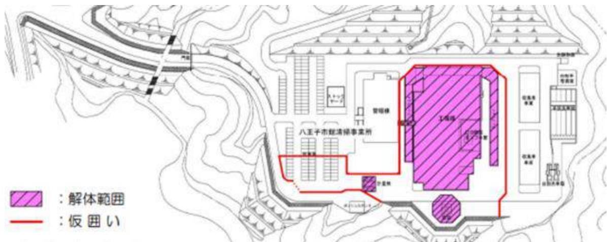
圖 7.3.2-1 八王子市清潔工廠拆除工程範圍
