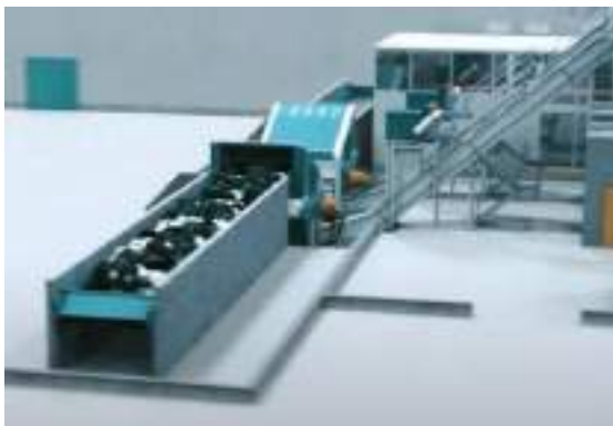
圖 3.2.2-2 步進式進料器及其油壓推桿
