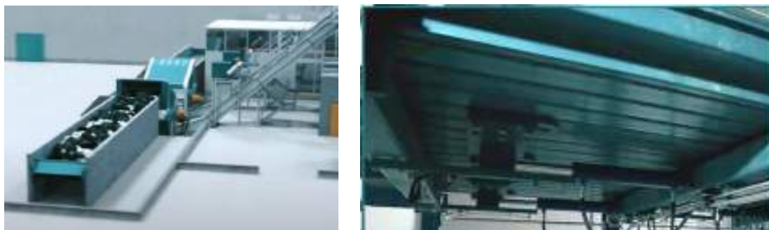
圖 3 步進式進料器及其油壓推桿
