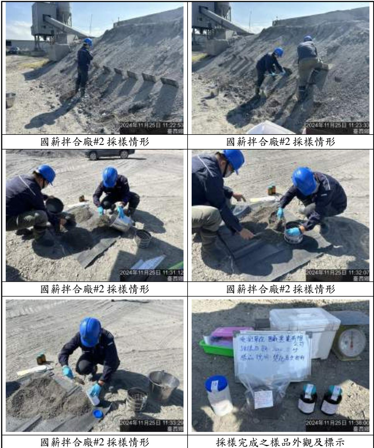
圖 4.2-2 焚化再生粒料採樣作業(6/12)
