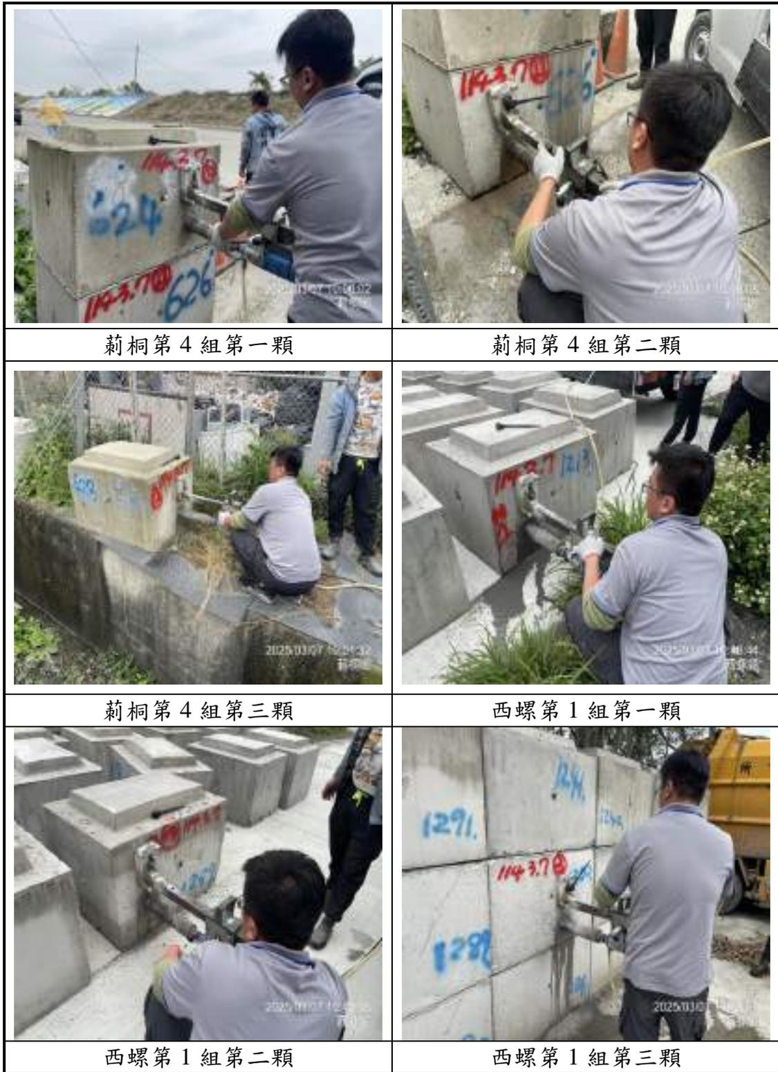
圖 6.2-3 立方磚鑽心試驗現場採樣情形(6/7)
