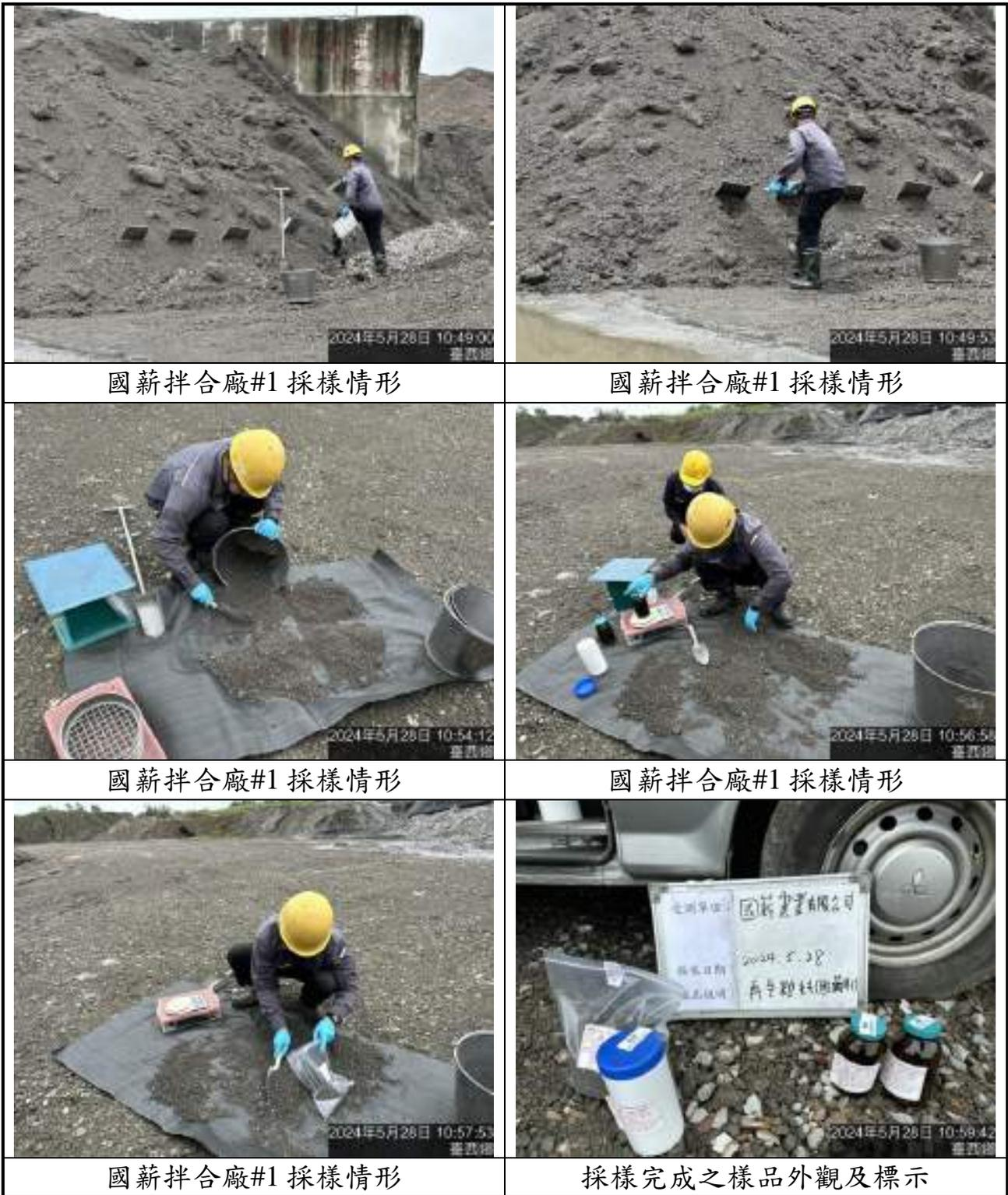
圖 4.2-2 焚化再生粒料採樣作業(2/12)
