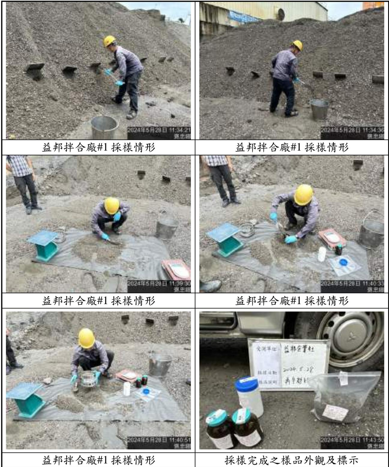
圖 4.2-2 焚化再生粒料採樣作業(3/12)
