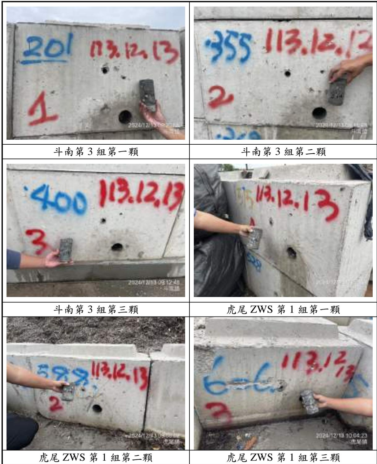
圖 6.2-4 立方磚鑽心試體(3/7)
