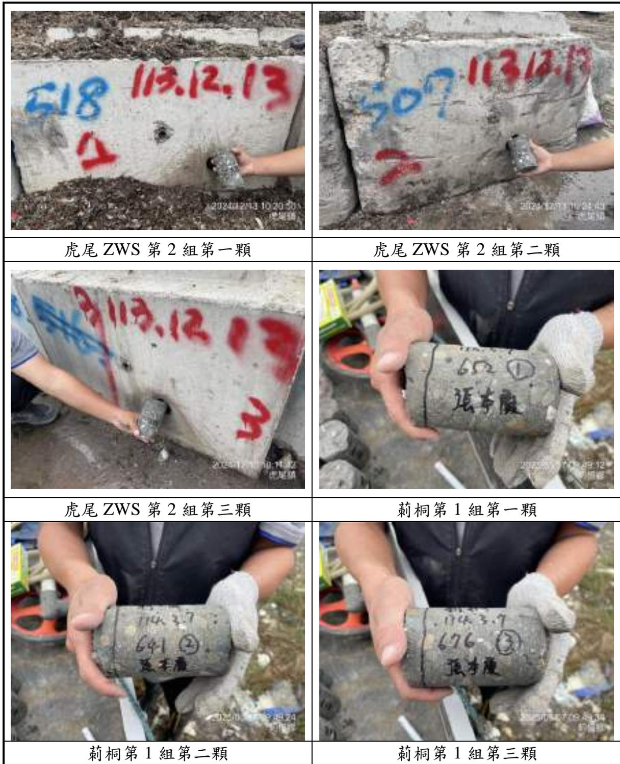
圖 6.2-4 立方磚鑽心試體(4/7)
