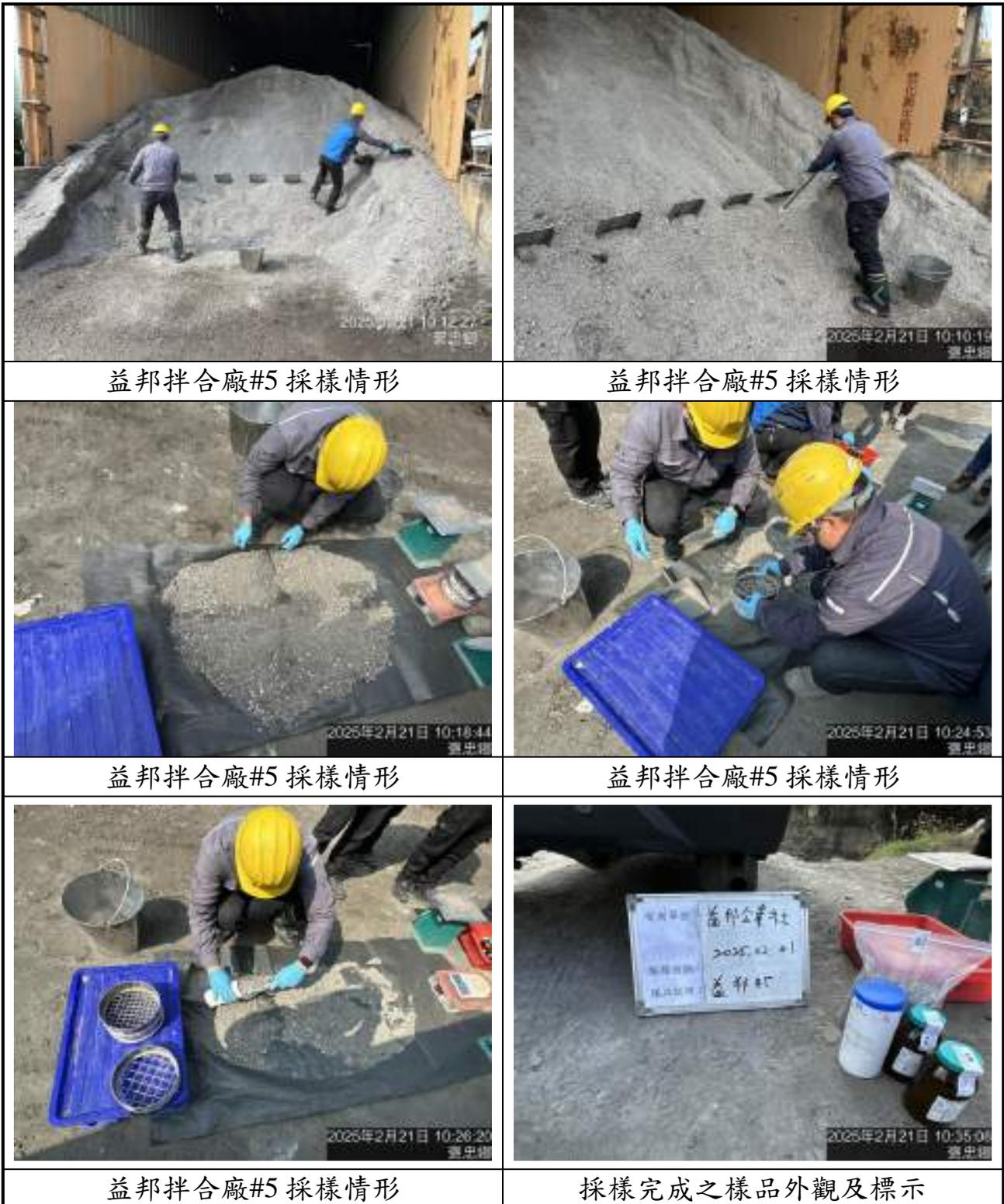
圖 4.2-2 焚化再生粒料採樣作業(12/12)
