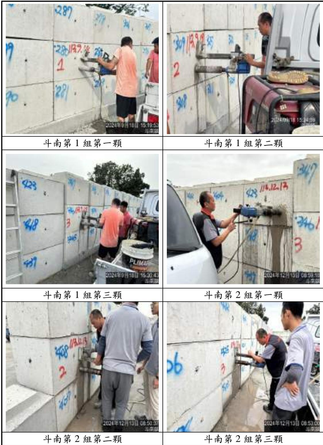
圖 6.2-3 立方磚鑽心試驗現場採樣情形(2/7)
