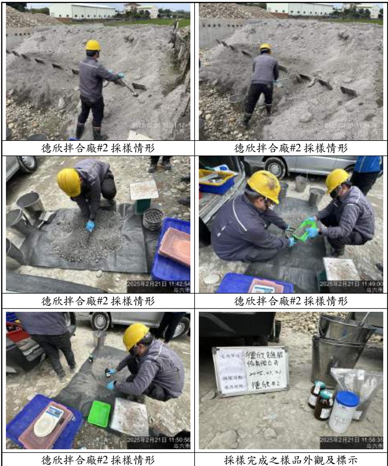
圖 4.2-2 焚化再生粒料採樣作業(11/12)
