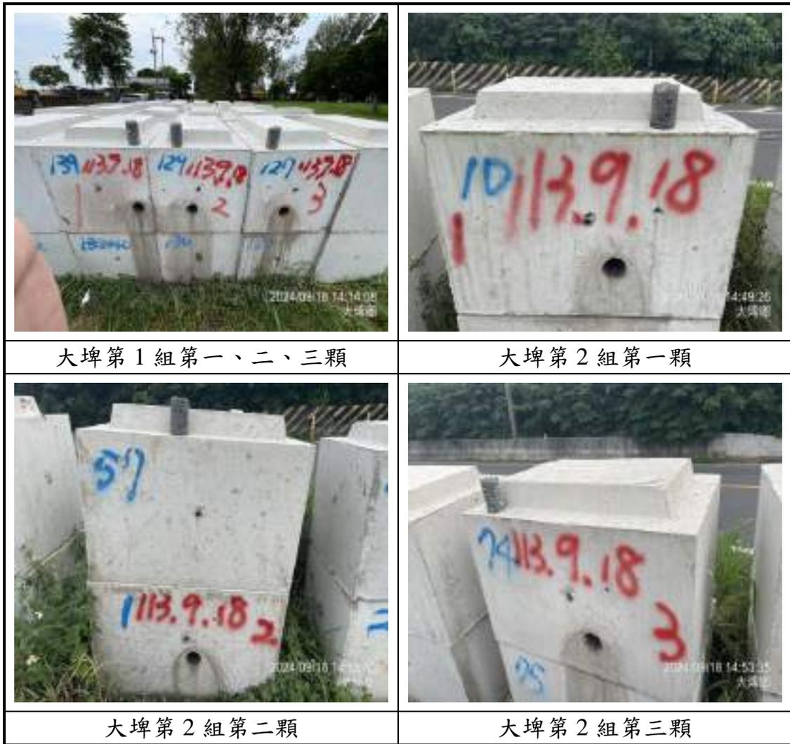
圖 6.2-4 立方磚鑽心試體(1/7)
