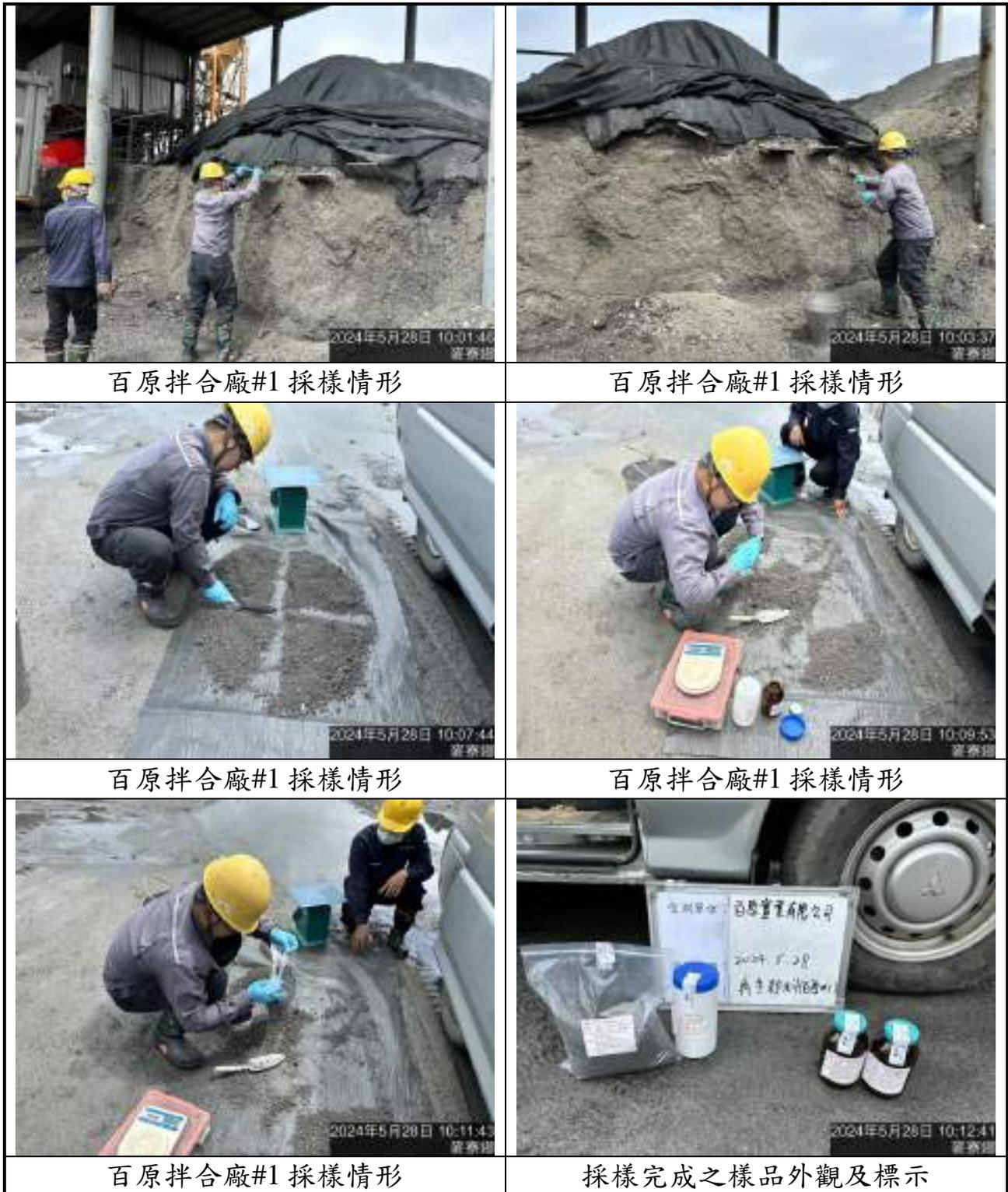
圖 4.2-2 焚化再生粒料採樣作業(1/12)
