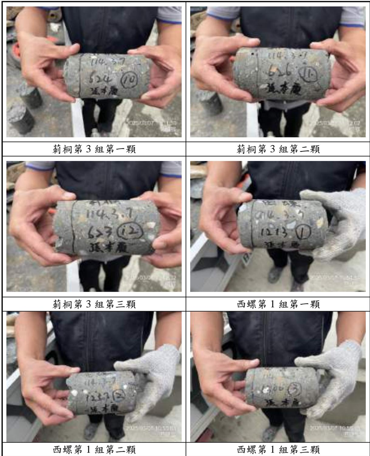
圖 6.2-4 立方磚鑽心試體(6/7)
