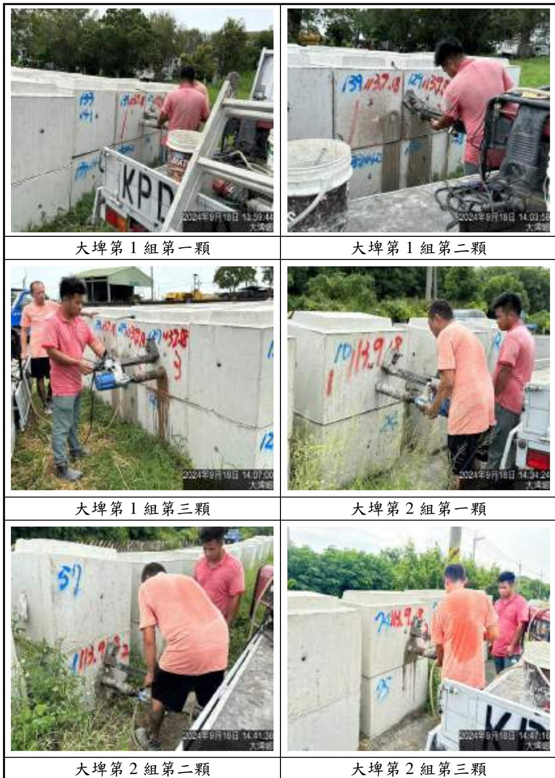
圖 6.2-3 立方磚鑽心試驗現場採樣情形(1/7)
