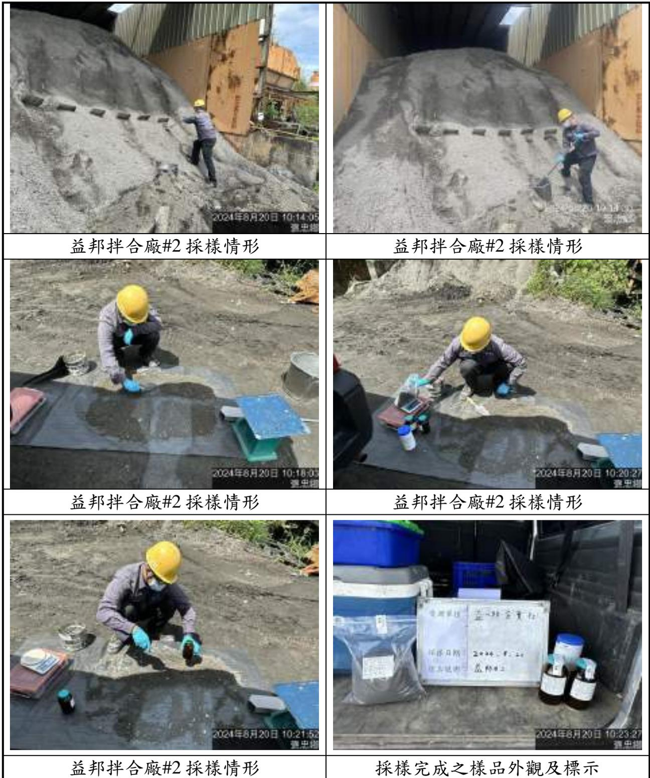
圖 4.2-2 焚化再生粒料採樣作業(4/12)
