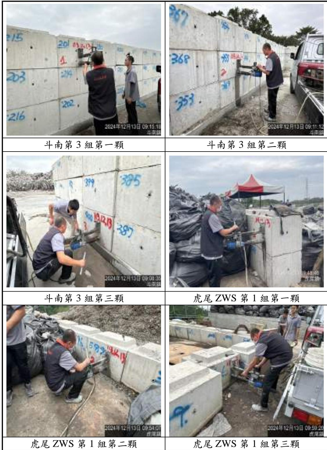
圖 6.2-3 立方磚鑽心試驗現場採樣情形(3/7)
