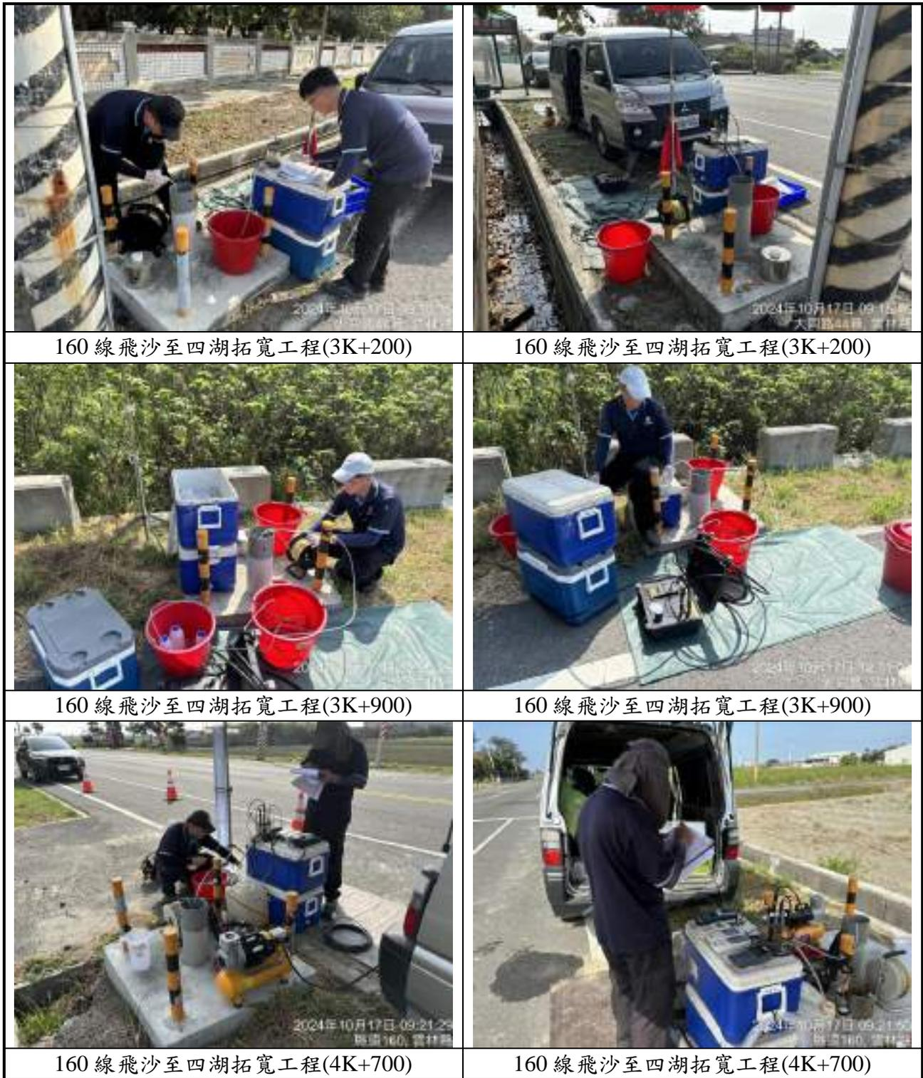
圖 4.3-6 環境監測地下水採樣作業(1/2)
