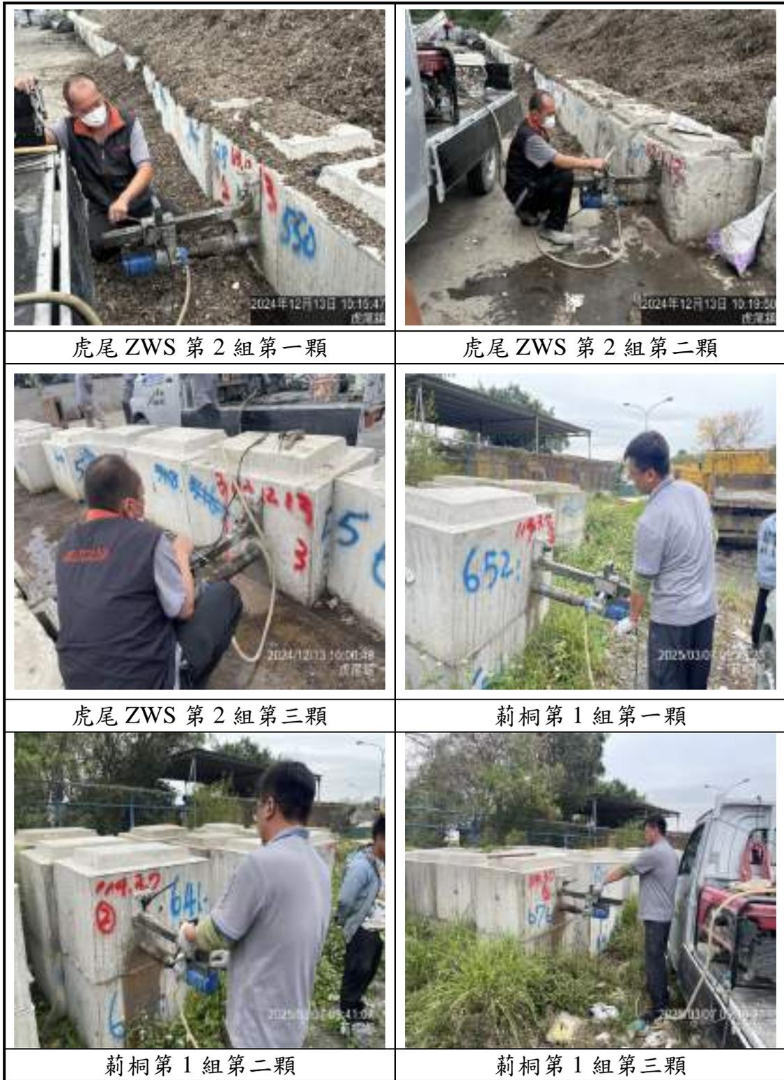
圖 6.2-3 立方磚鑽心試驗現場採樣情形(4/7)
