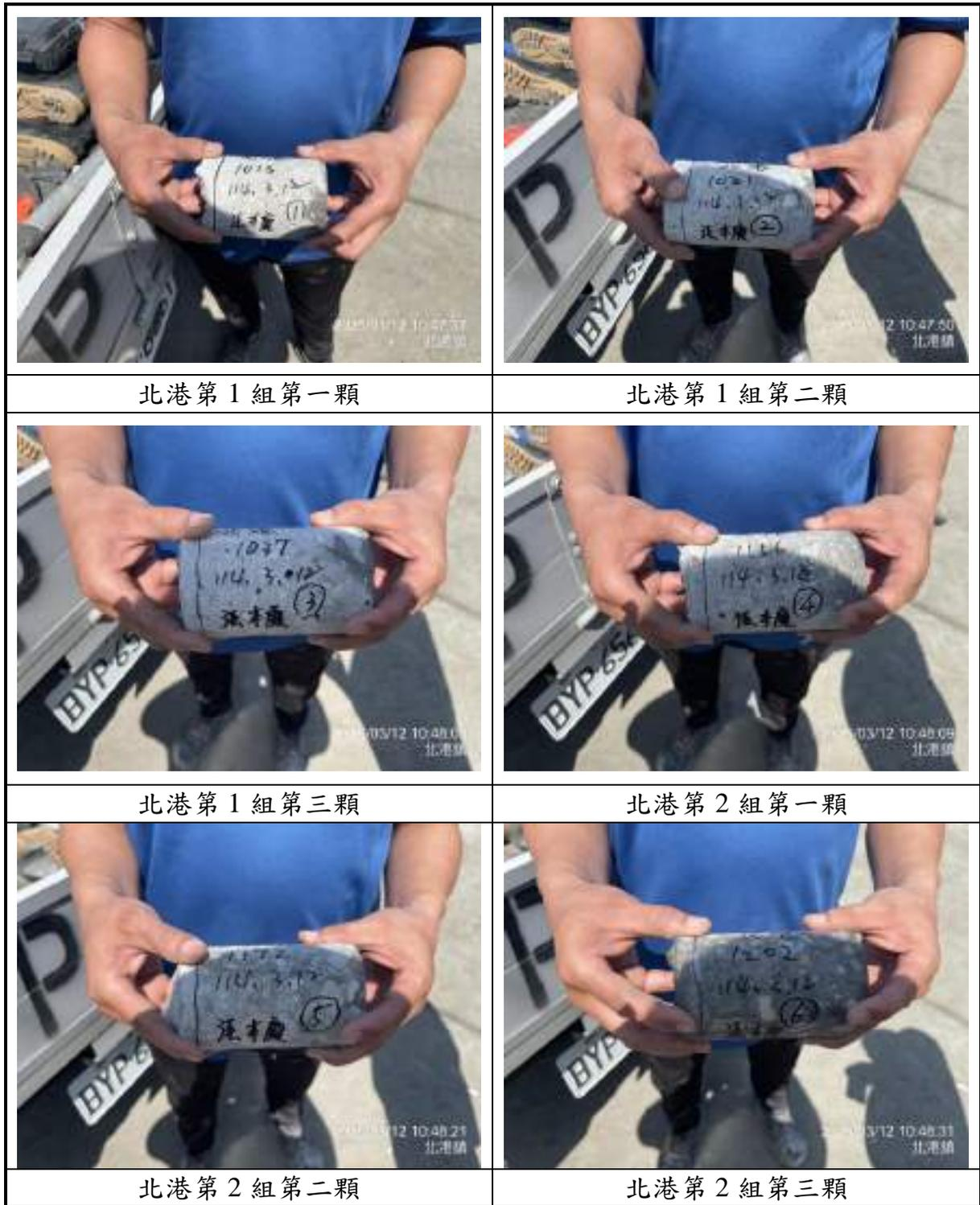
圖 6.2-4 立方磚鑽心試體(7/7)
