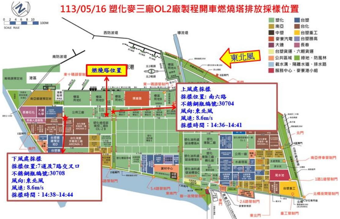
圖 4.6-1、燃燒塔排放火光進行不銹鋼瓶採樣相對位置圖(以 113/5/16 塑化 OL2 廠為例)
