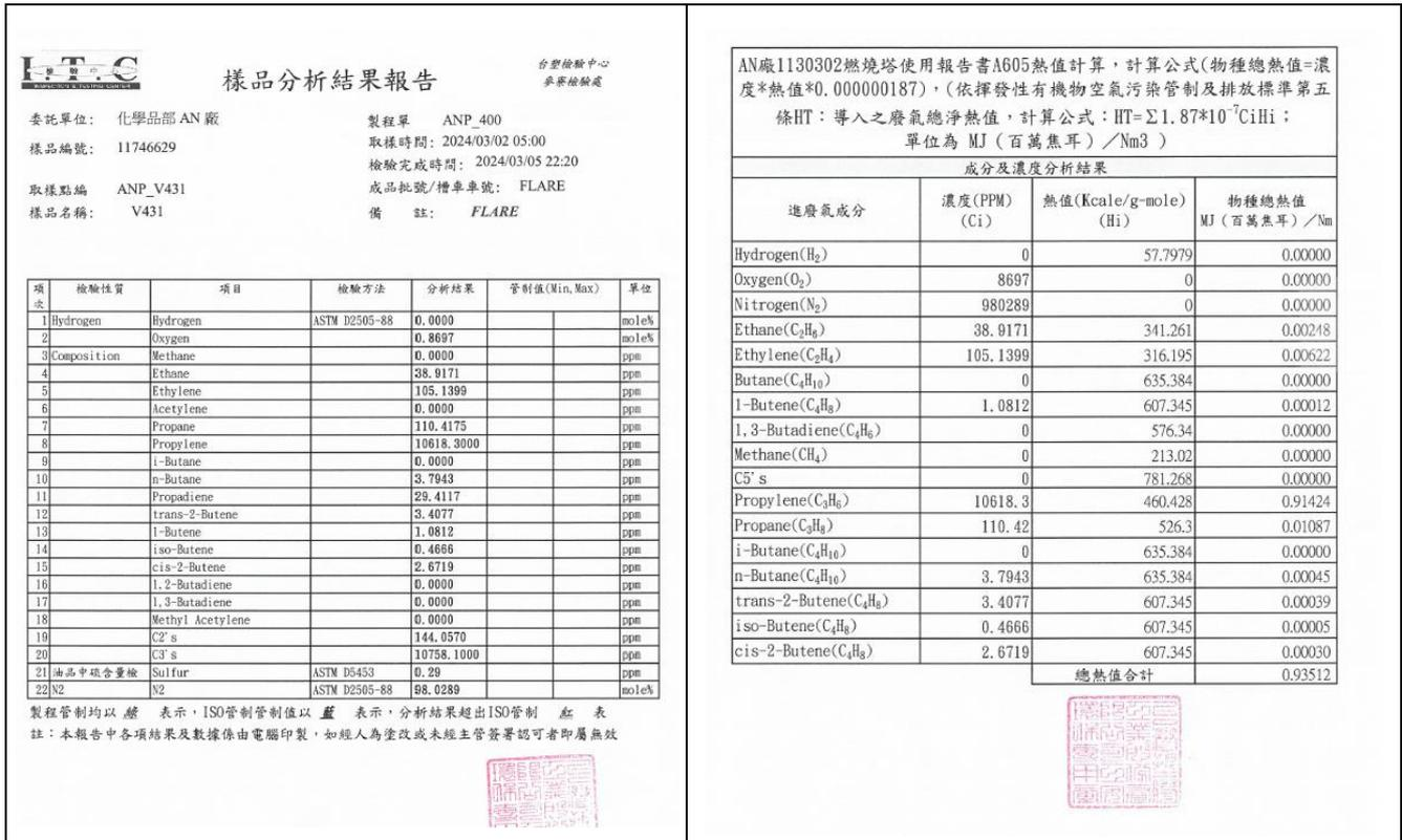
圖 4.2-3、113 年 3 月 2 日台塑麥寮廠 AN 廠燃燒塔 A605 熱值分析
