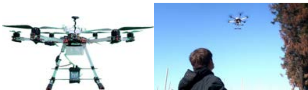
圖5.4 空污監測專用之多旋翼無人載具系統
