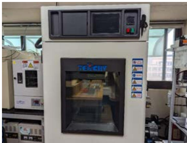
圖5.7 中央大學大氣系之標準氣象校正設備
