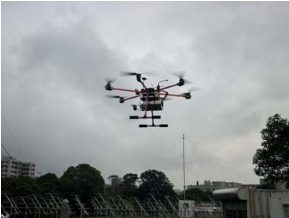
圖5.6 氣體採樣罐安裝於無人機上的示意圖
