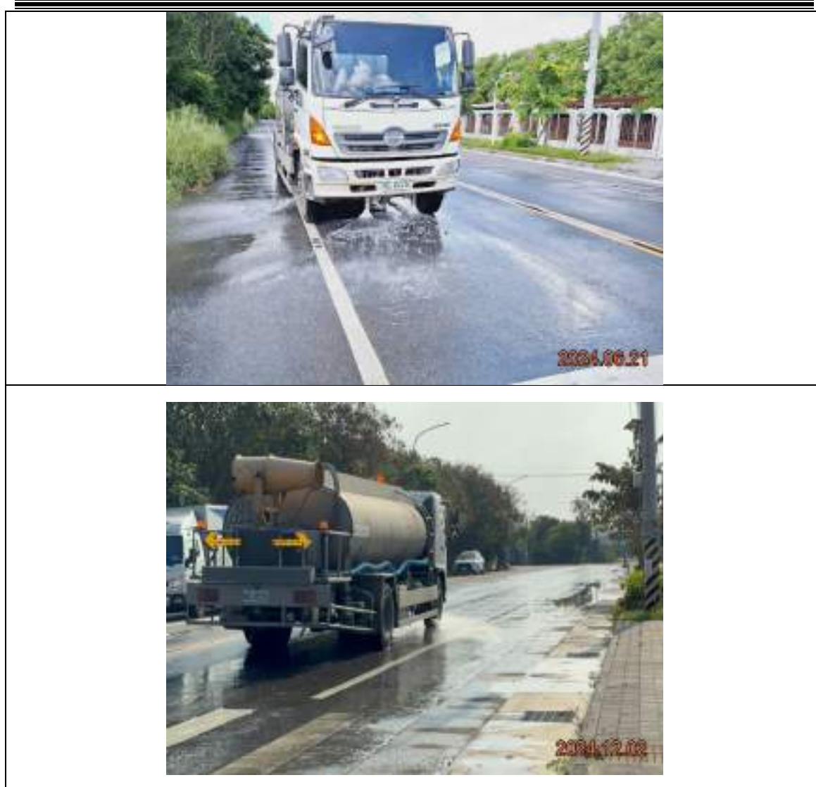
圖 4.4.5-1 霧砲除塵及道路髒污支援作業情形
