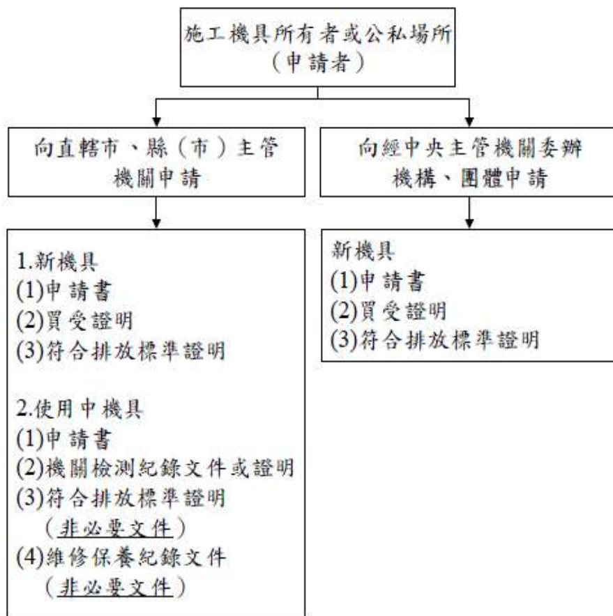
圖 3.2-1 施工機具自主管理標章核發申請流程
