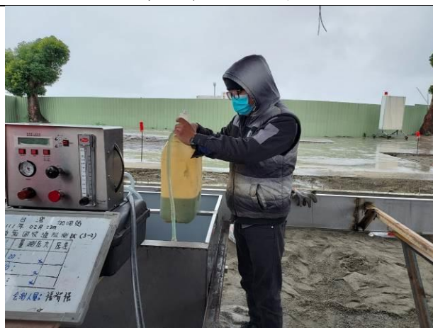
圖 5.6-2、台灣加油站油氣回收設備液阻檢測
