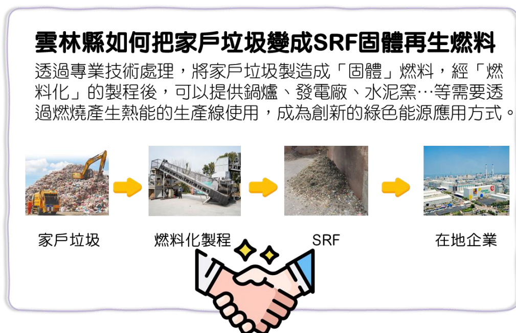
圖 7.1-3 雲林縣家戶垃圾轉製固體再生燃料及應用方式
