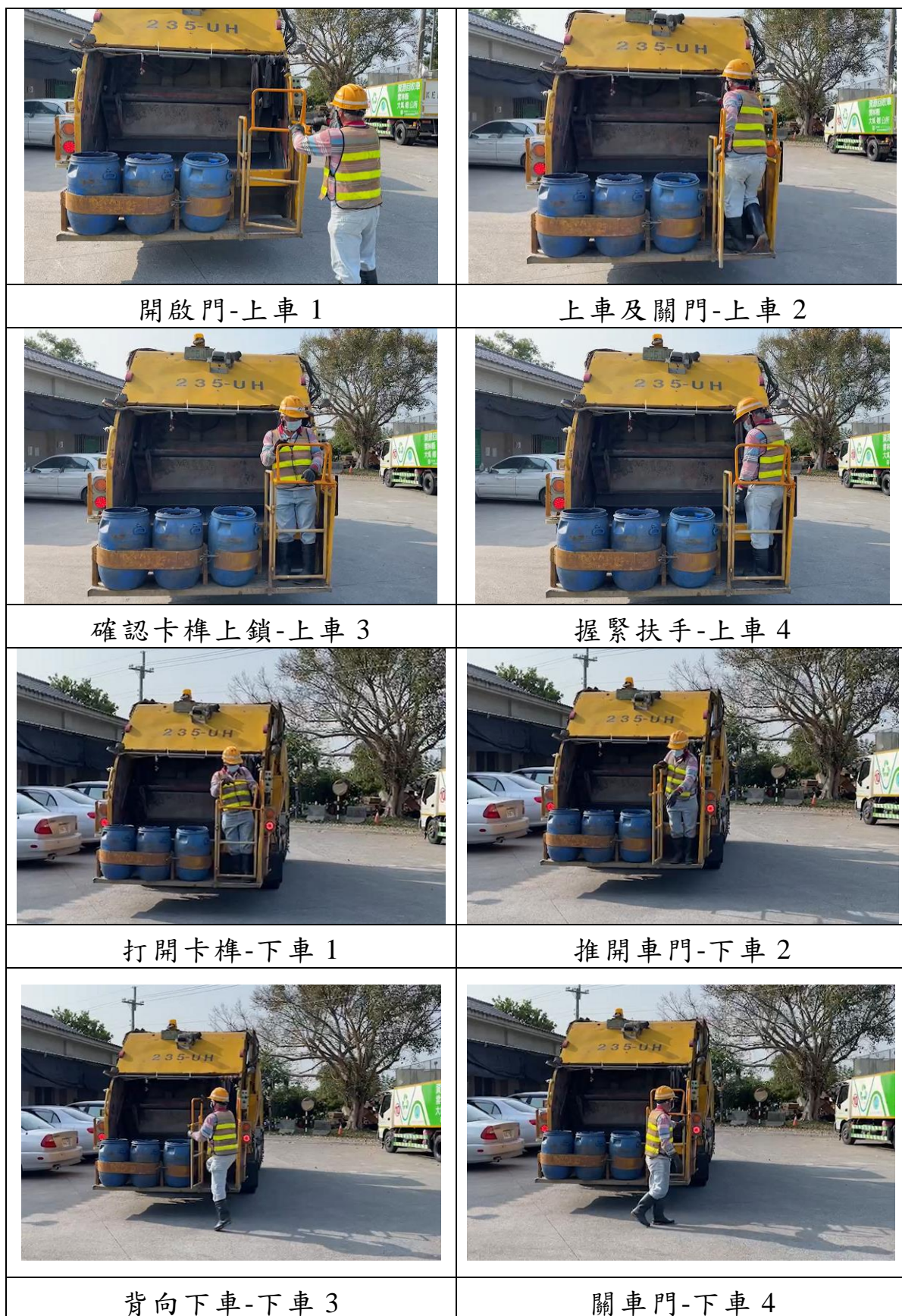
圖 3-33、清潔隊員上下車實際示範(全封閉-單邊向外開啟方式)
