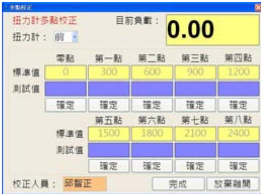
圖 5.4-2 高幅扭力計多點校正畫面
