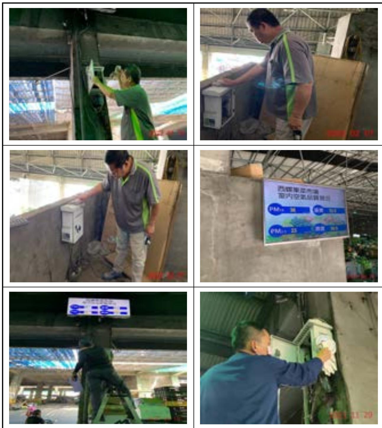
圖 6.2.1-4 西螺果菜市場微型偵測器維護保養照片
