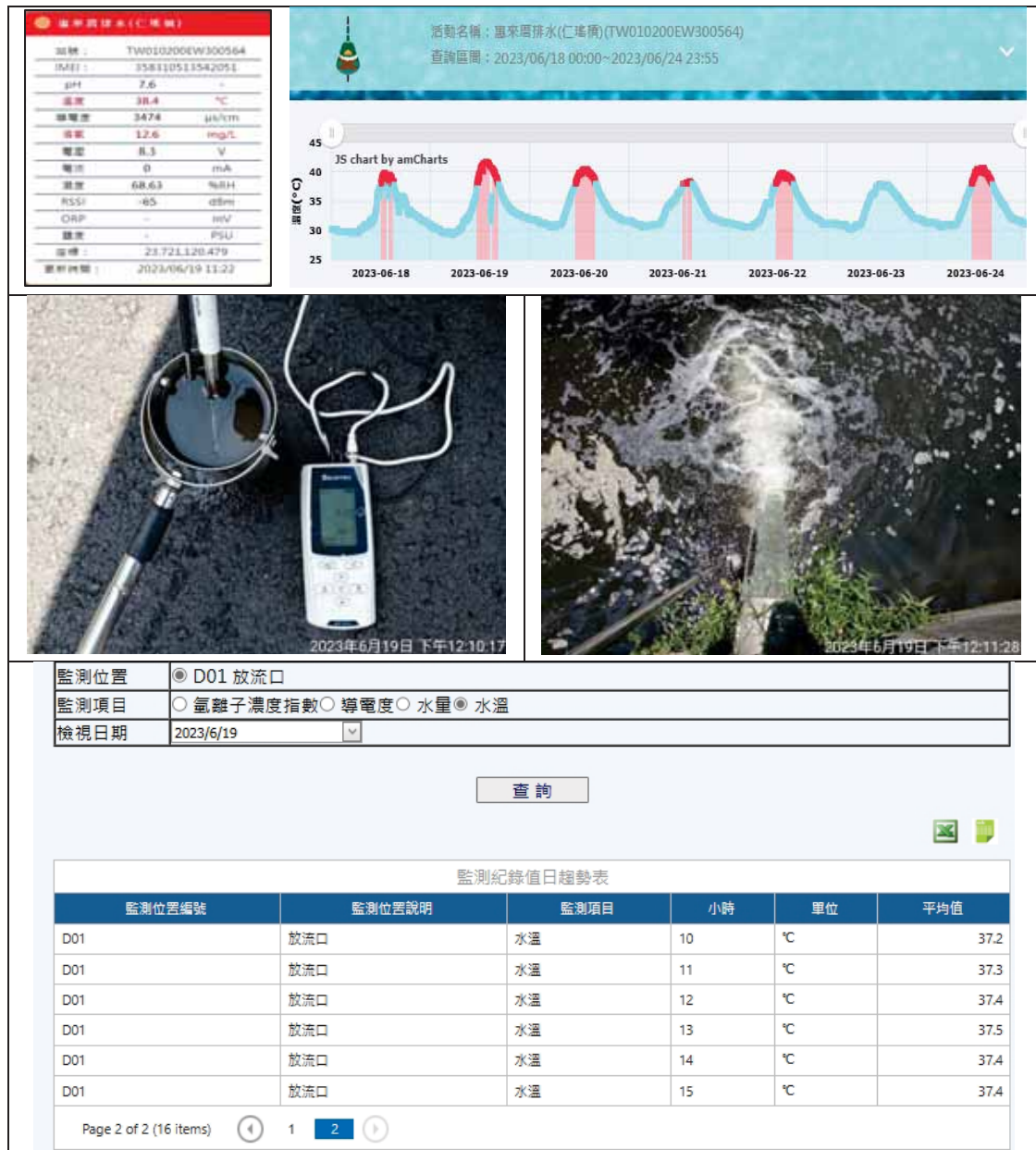
圖 4-3-11 惠來厝排水(仁瑤橋)水質異常狀況
