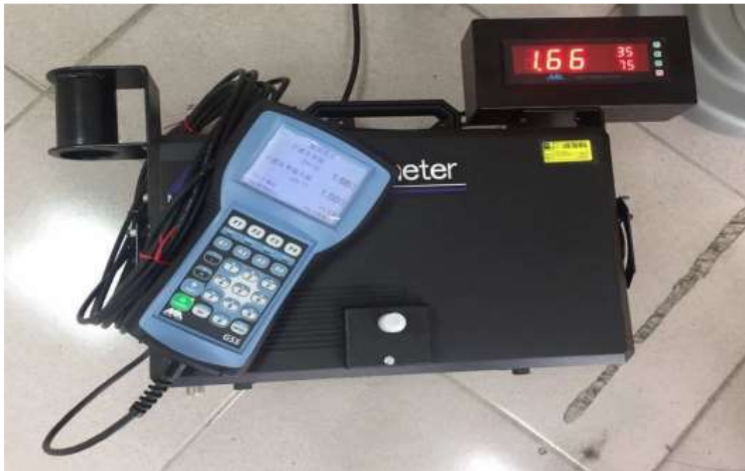
圖 3.2-1 光學式煙度試驗器 MA-200A 及多功能顯示器 G55
