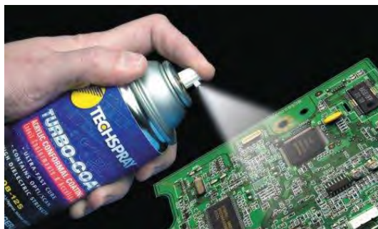
圖2-2 電路板防水膜示意圖
