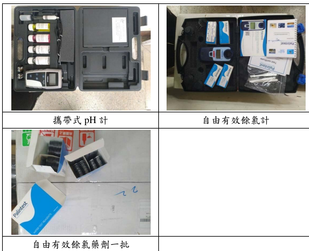
圖 4.8-1、購置並提送之檢測設備
