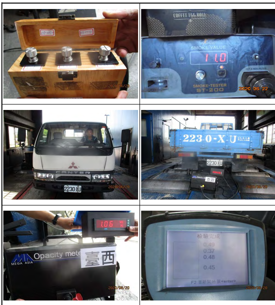
圖 6.3.3-1 煙度計比對照片
