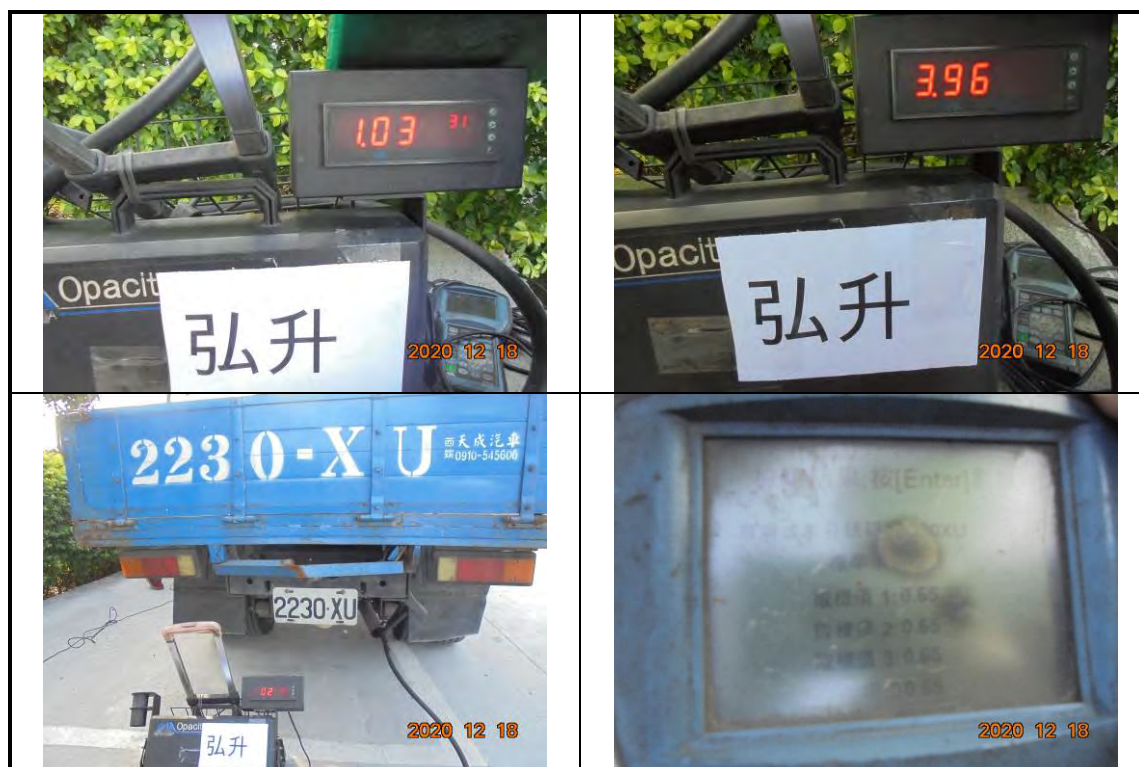
圖 6.3.3-16 弘升保養廠煙度計比對照片
