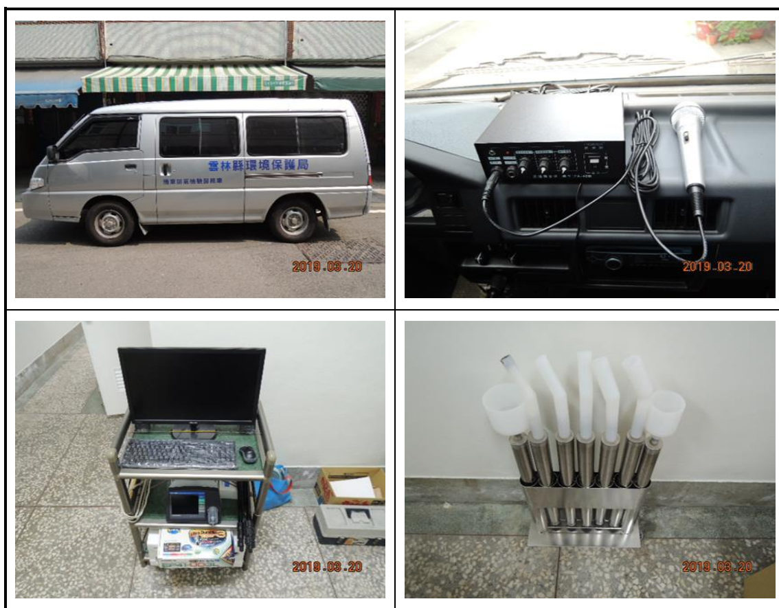
圖 4.3.2-1 移動式機車排氣檢驗站設置完成
