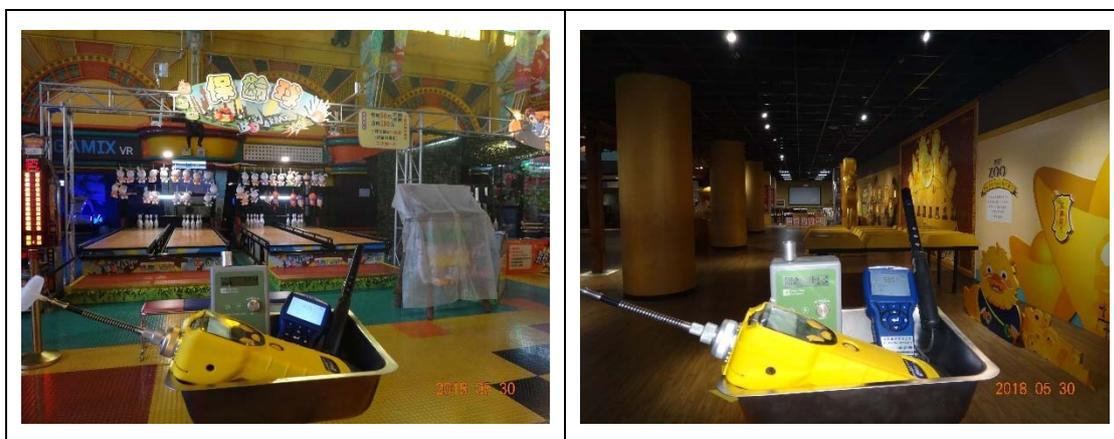
圖4.9.8 大型遊樂場所室內空氣品質量測情形
