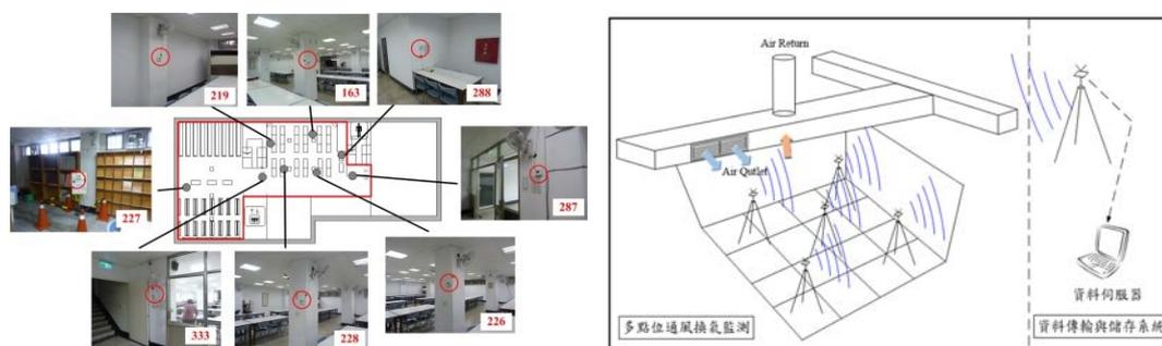
圖3.5.1 室內空氣品質自動連續監測示意圖
