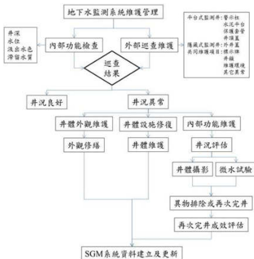
圖 3.1-1、地下水監測井維護管理作業流程圖
