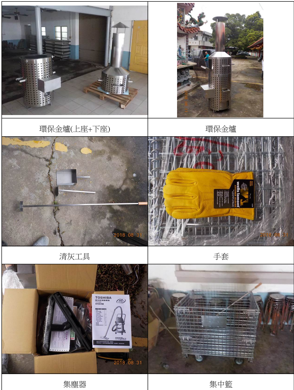
圖 5.5-13 可移動型環保金爐及相關設備照片
