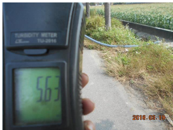
圖 3.7.2-1 使用濁度檢測計現場量測水質情形
