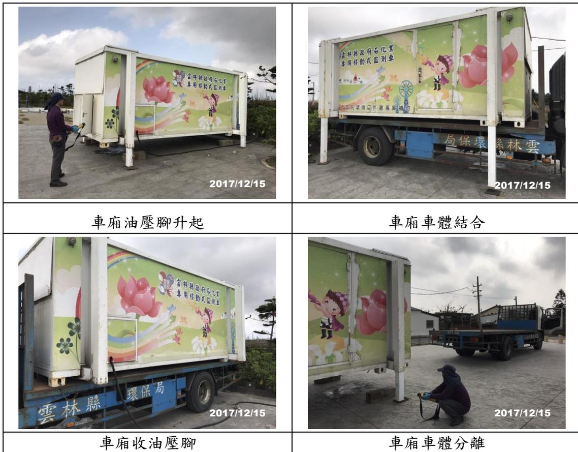
圖 3.1-10 車體車廂結合與分離作業
