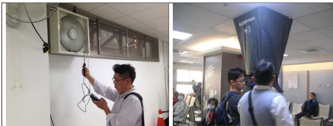
圖3-5.2 通風換氣量測示意圖
