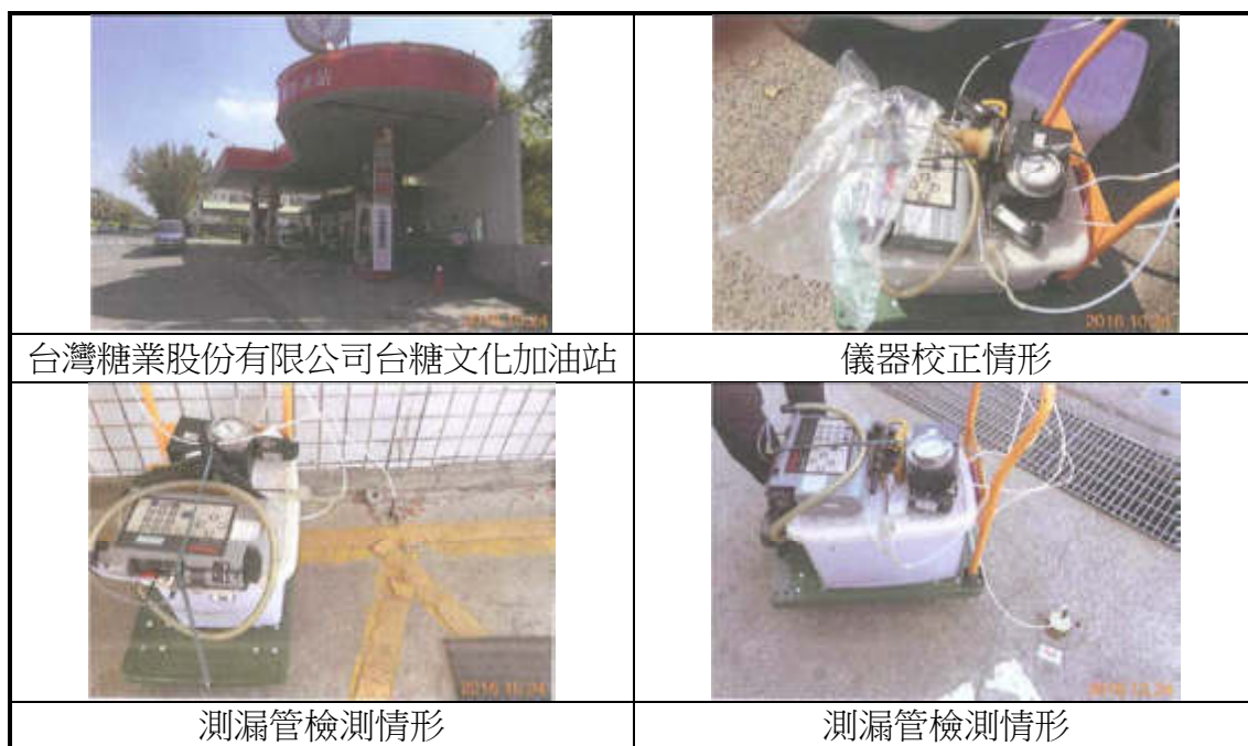
圖 4.5-26、台灣糖業股份有限公司台糖文化加油站測漏管檢測採樣情形
