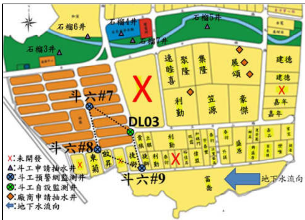
圖 4.2-8、斗六工業區抽水井資訊及自計式水位計擺設位置示意圖
