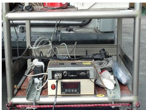
圖 4.20.1-1 自備震動式轉速計一套照片
