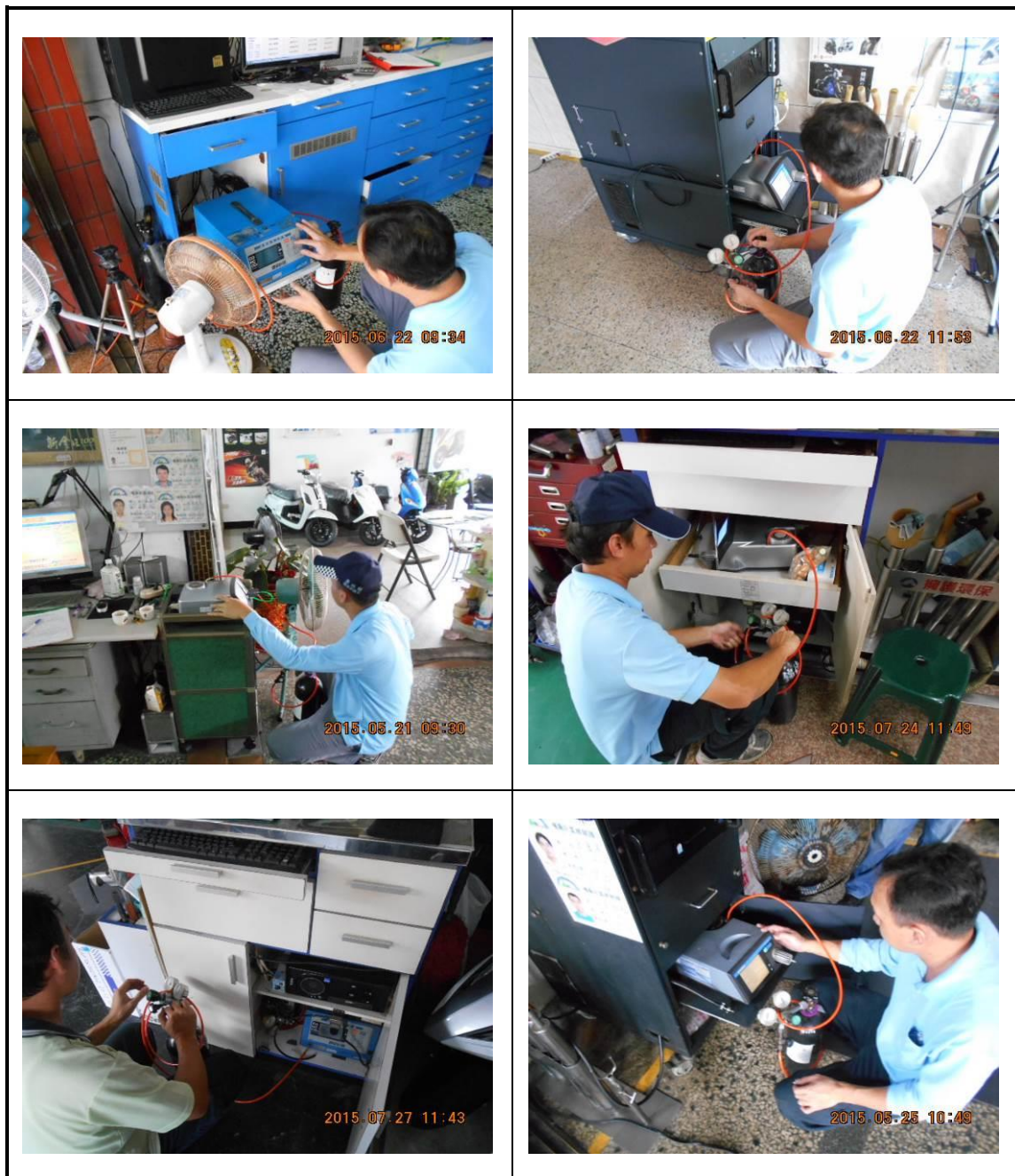
圖 4.8-2 儀器標準氣體比對之現場查核實況照片
