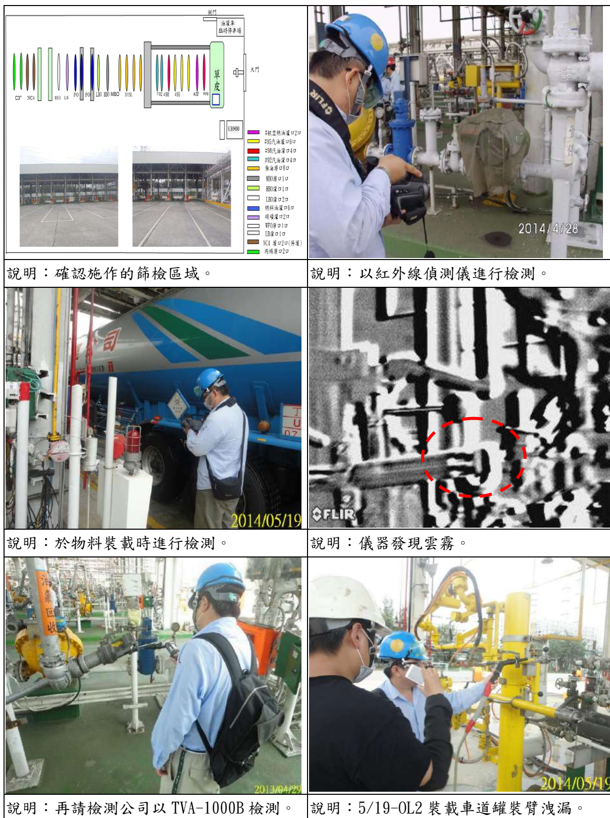
圖 5.3-1、裝載操作設施紅外線氣體成像儀篩檢工作方法(1/2)
