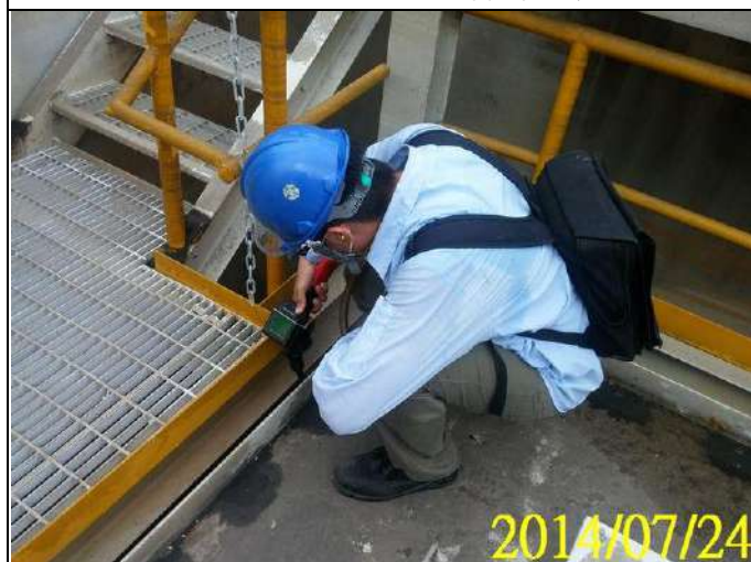
圖 7.2-2、污泥處理設施、油水分離池氣密查核情形
