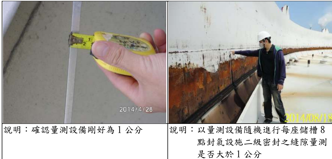
圖 4.2.5-2、外浮頂槽縫隙量測情形
