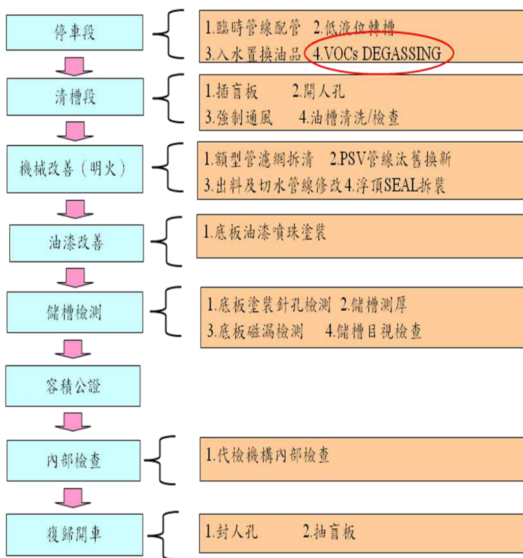
圖 4.3-1、清槽作業流程圖
