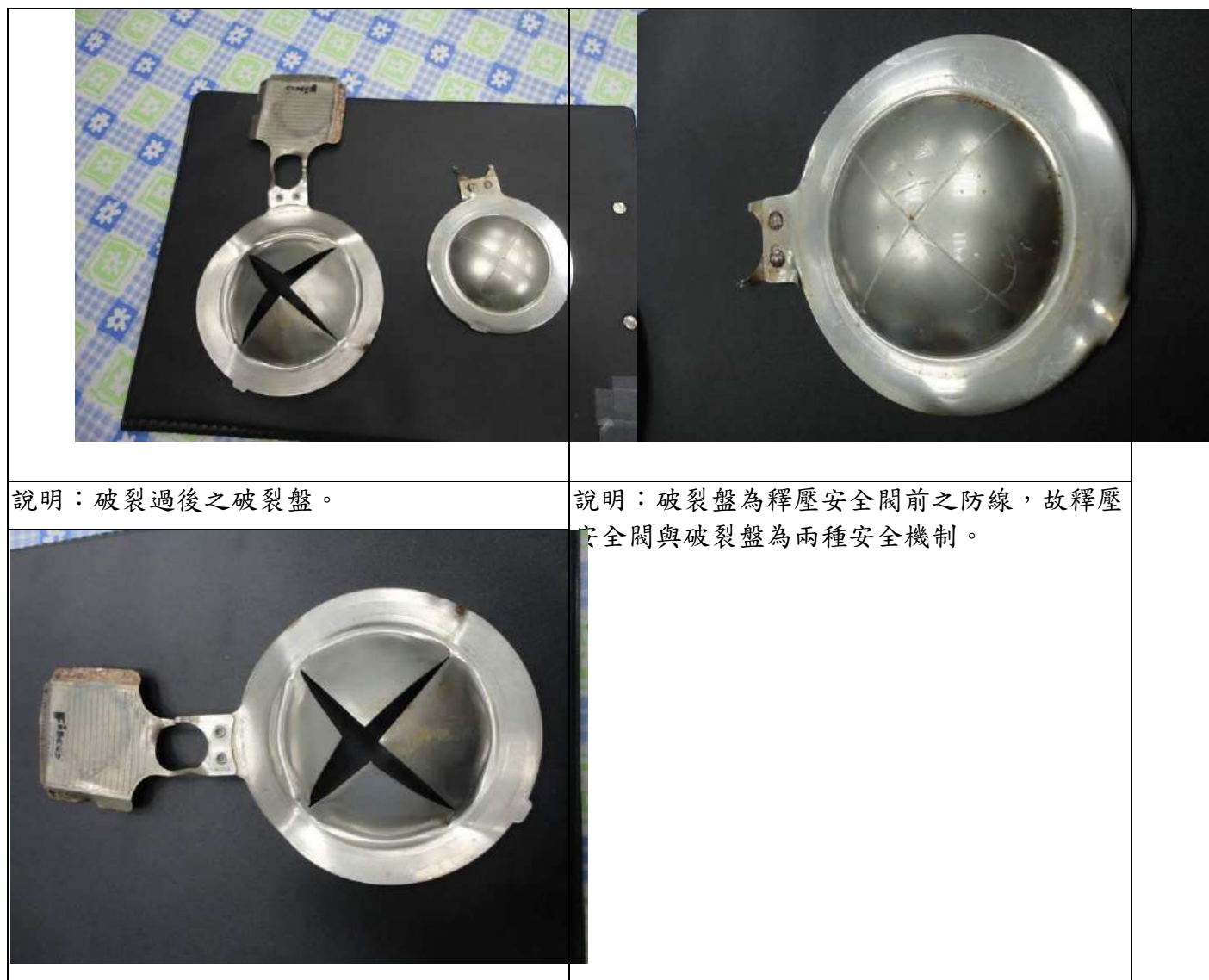
圖 6.3-1、釋壓閥剖面圖及破裂盤介紹
