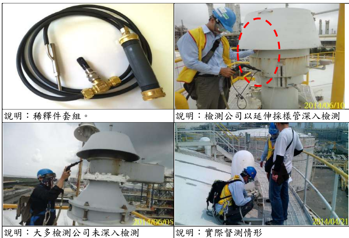
圖 4.2.4-1、內浮頂槽上方督測情形
