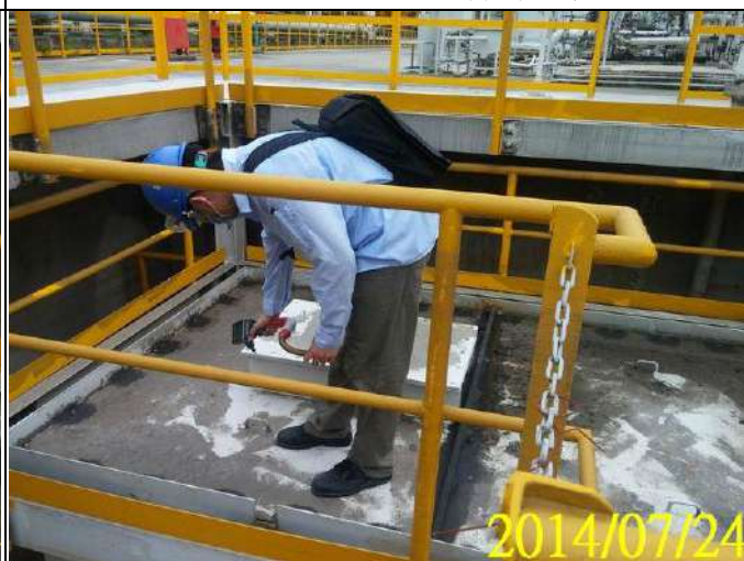
圖 7.2-2、污泥處理設施、油水分離池氣密查核情形
