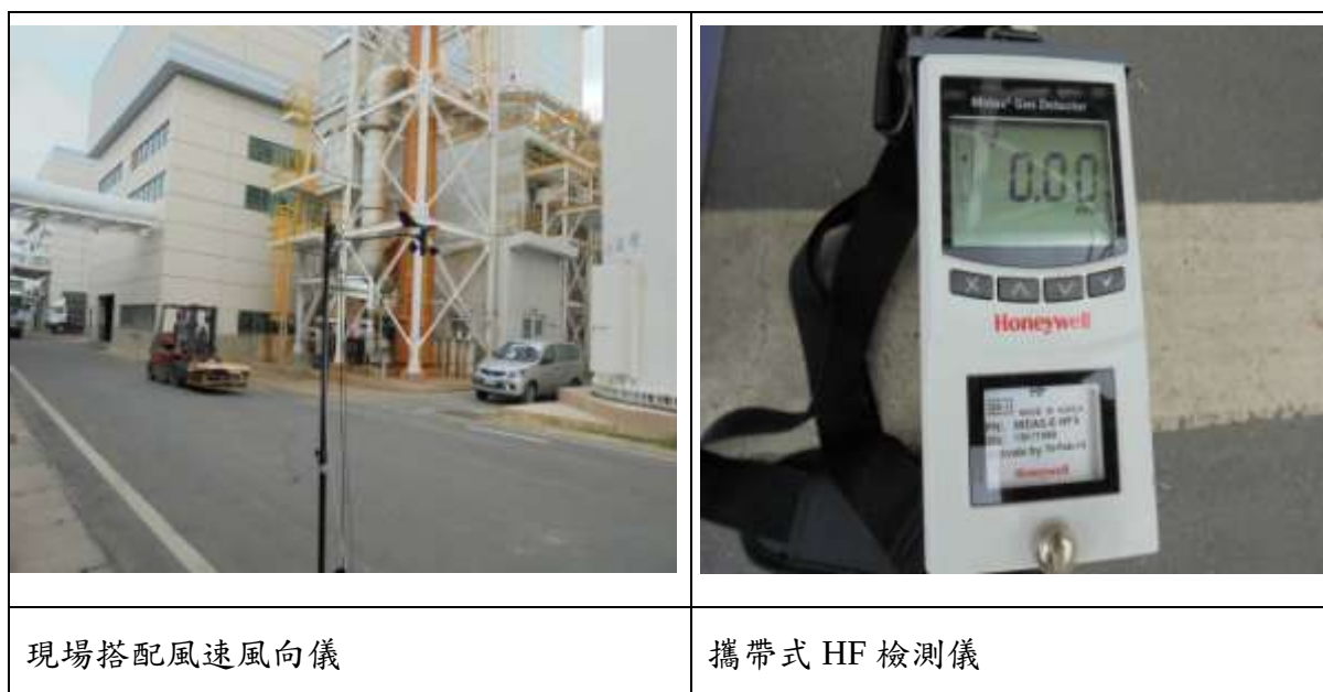
圖 4.2.2-1、攜帶式 HF 檢測儀現場檢測照片
