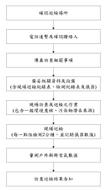
圖3-1.1 室內空氣品質巡檢作業流程
