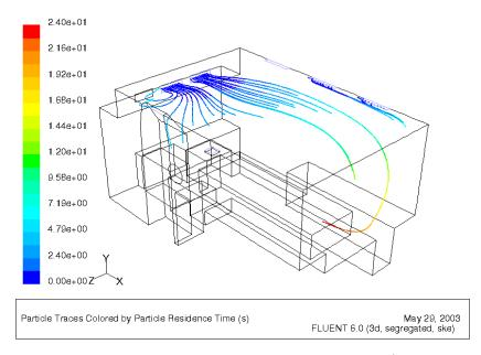
圖3-3.4 出風口送風流場CFD模擬評估示意圖
