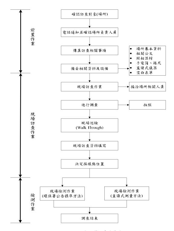
圖3-1.5 室內空氣品質調查作業流程
