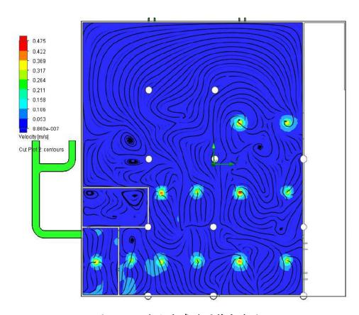
圖4-6.19 輕鋼架處流場等高線圖
