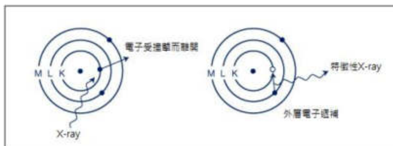
圖 3.1-10、XRF 基本原理圖
