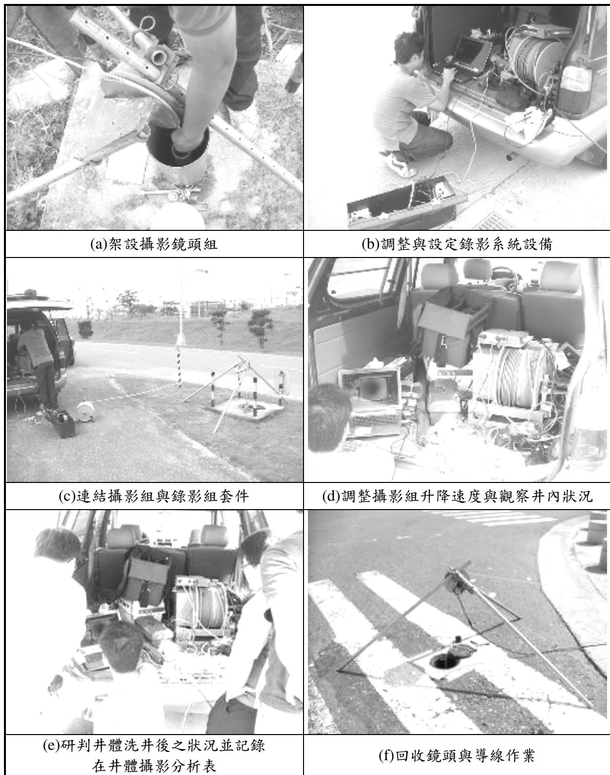
圖 3.2-3、井體攝影實際執行方式相片圖解
