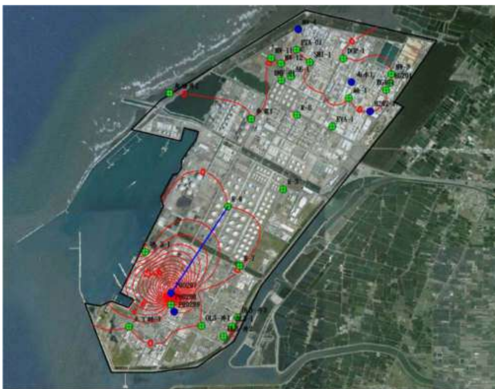
圖 4.4-9 TPH-D 污染物分佈情況(藍線為 TPH-D 污染物傳輸距離)
