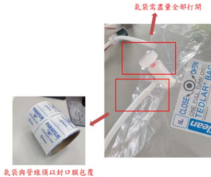
圖 3.氣袋安裝操作
